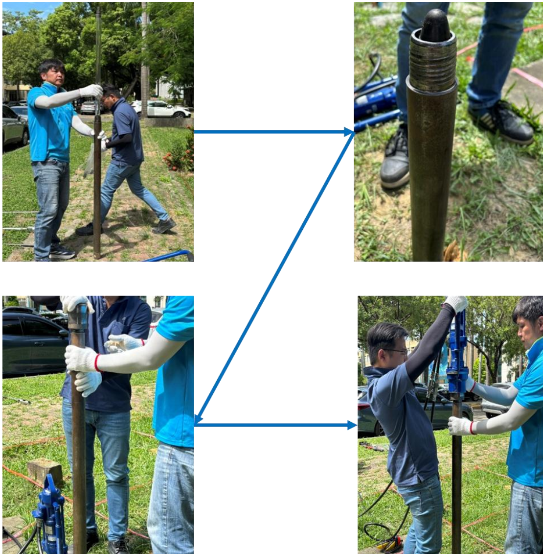
圖 41、油壓動力裝置及其操作過程
