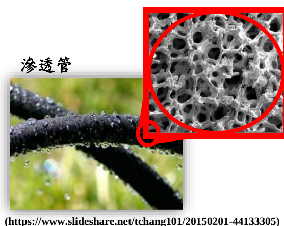
圖 15、滲透管緩釋氧化劑液體之示意。
