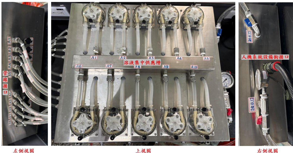
圖 27、機電控制系統蠕動馬達整合箱外觀照片 (左側為滲透管管線接口；右側為入流口、壓力錶、溢流口以及銜接口)
