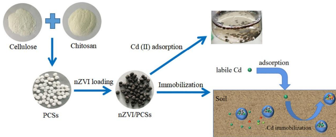
圖四、文獻中運用 nZVI/PCS 複合材料吸附土壤中鎘之機制
