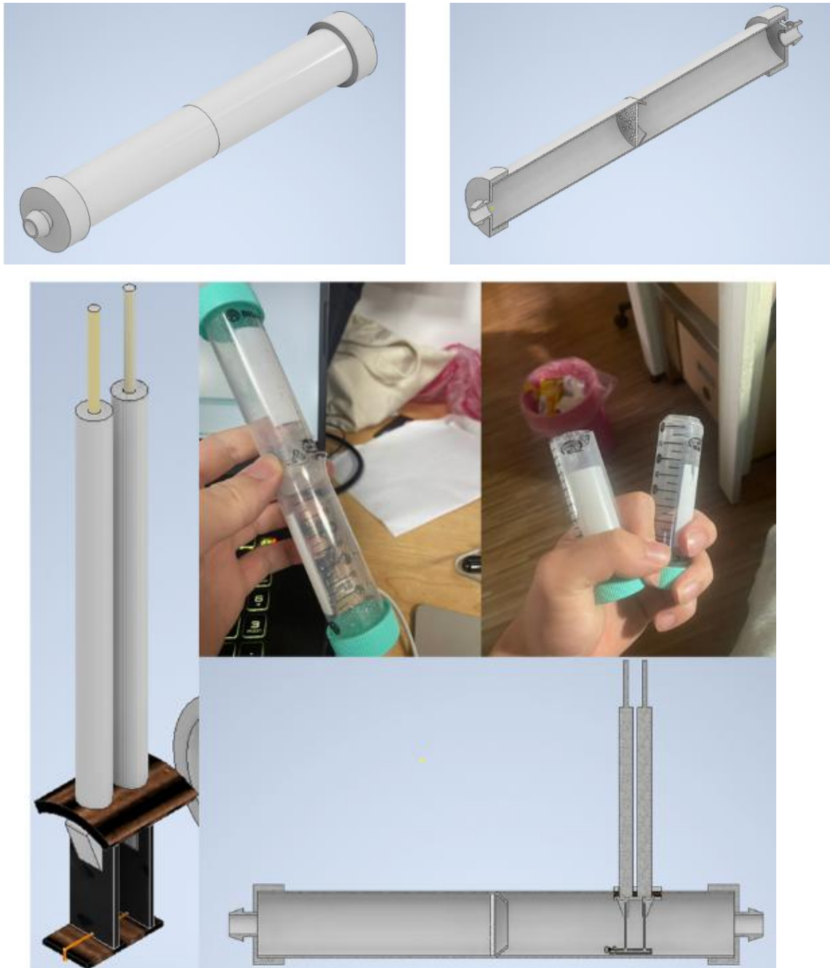
圖 56. 三通式透明模具設計圖與實體圖展示
