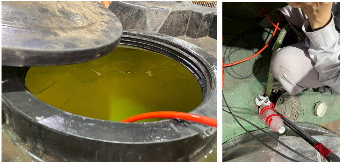
圖 28 藥桶內放置冰磚降溫，並緩慢注入至井內，由布置於井中之 DTS 量測溫度變化
