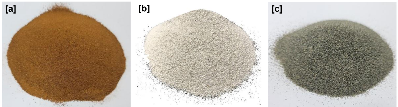
圖 13 填充砂箱之隙介質。[a]陽明山紅土、[b]石英砂、與[c]川砂(再篩選分為為細、粗兩類)
