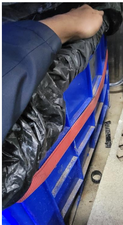
圖 11 側土壓使箱壁外推變形圖
