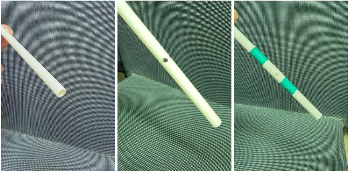
圖 18 白色 PVC 管與製造。從左到右分別為：原管件、鑿孔、及包不織布。
