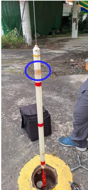
圖 75 現地貝勒管取樣及 TDR 資料分析；(左)貝勒管取樣，藍色圈起處有明顯浮油層存在。(右)局部正規化互相關分析，紅色空心圓點為實驗室建立之基準值，黑色實線為基準值回歸線，綠色實心圓點為量測資料，藍色虛線為判斷浮油層是否存在之閾值。
