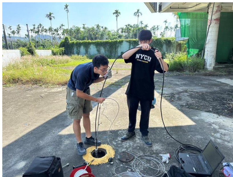
圖 74 將感測器藉由鋼索懸吊於監測井內
