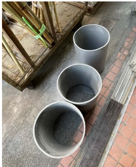
圖 5 長 40 cm 之 12 英吋 PVC 管
