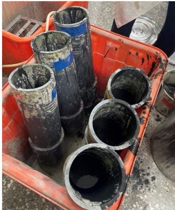
圖 9 待進行 ISPIE 之底泥管柱
