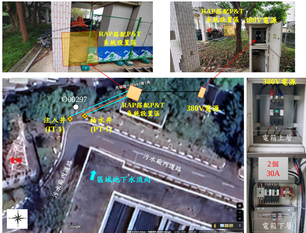
圖4.3-13 RAP 搭配 P&T 系統設備空間配置圖
