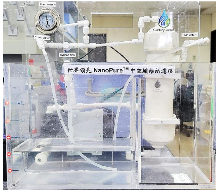
圖4.2-4 實驗室 NF 模組及示意圖
