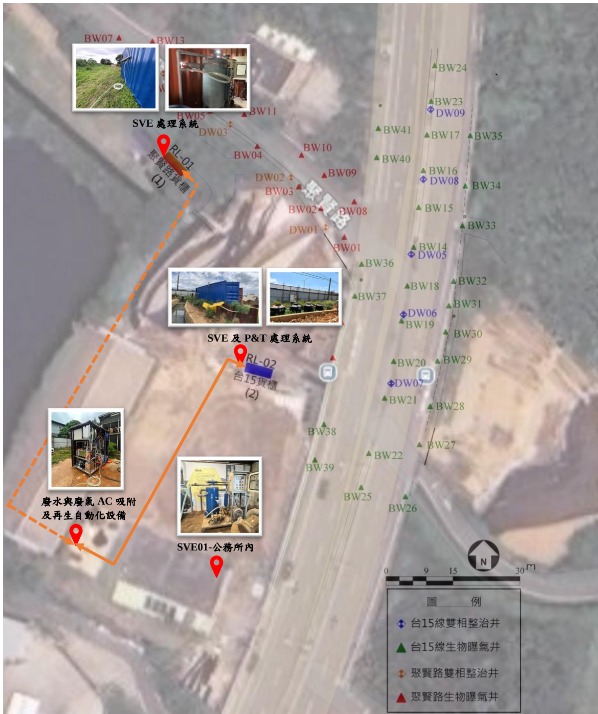
圖 三十九、將原在 RL-01 聚賢路 SVE 處理系統之管線遷至 RL-02 台 15 貨櫃 SVE 處理系統
