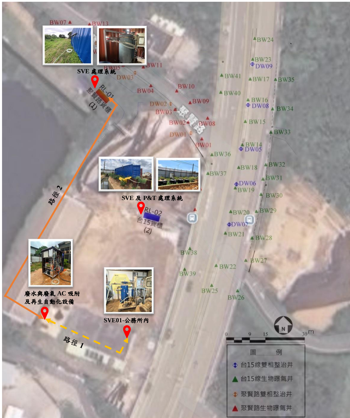
圖 三十五、將原在 SVE 01-公務所內之管線遷至 RL-01 聚賢路 SVE 處理系統
