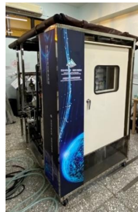
圖 六、AC 吸附及再生自動化設備
