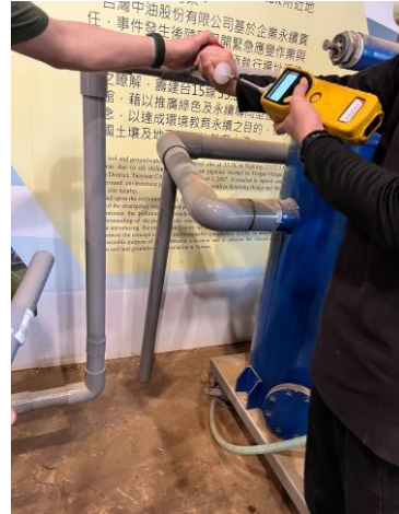
圖 二十八、使用攜帶式PID 偵測器偵測現場TVOC 濃度
