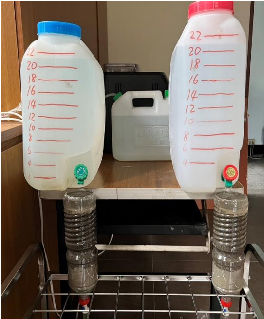
圖 4-14 實驗室滲漏試驗現況圖
