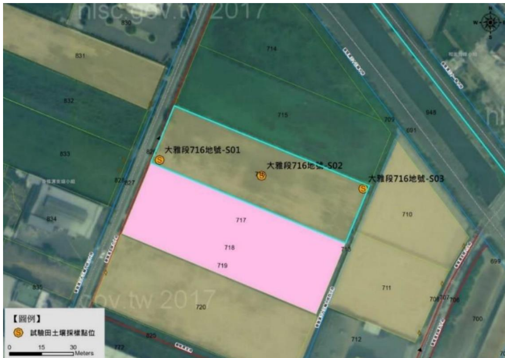
圖 4-8 水田監測裝置埋設空間分佈圖(以大雅段 716 地號為例)
