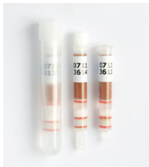
圖 3-1 (b) Sorbisense™ 各種類型之吸附管配件
