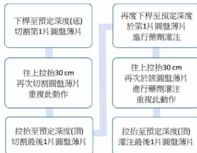
圖 4.3.2-1、水刀注藥施作流程示意圖
