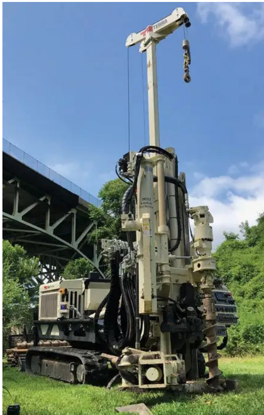
圖 7 Geoprobe® 7822DT 地質鑽探機(Geoprobe®, 2020)
