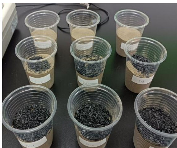
依比例秤取污染土壤及複合材料
