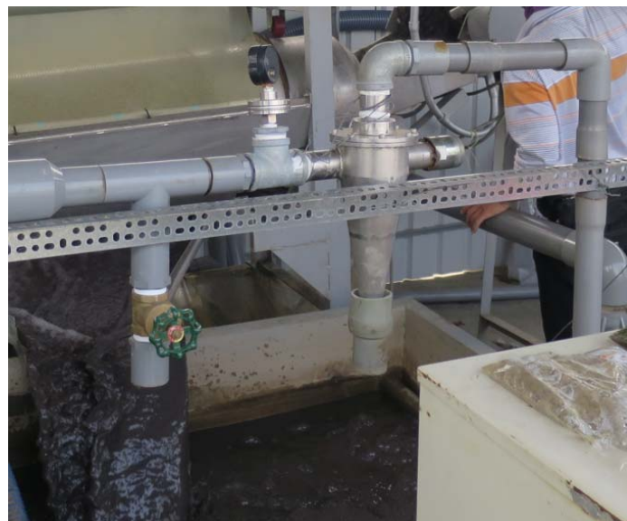
圖 3-1 水力漩流分離器之結構與組裝照
