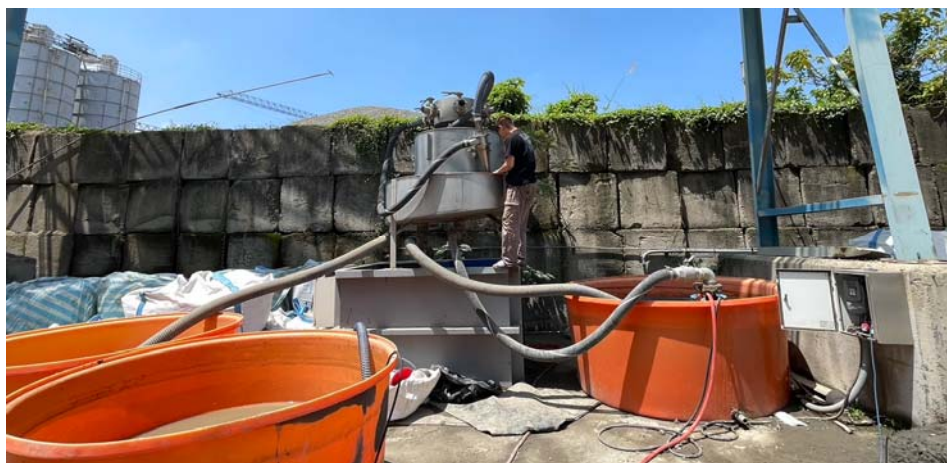
圖 5-25 實廠水力漩流分離試驗照片
