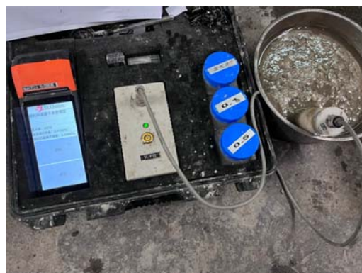
圖 5-31 氯離子量測過程照片
