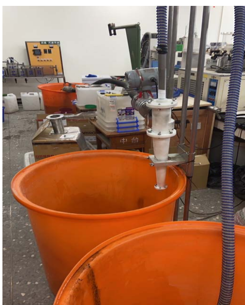
圖 5-21 3D 列印水力漩流管架於系統上照片
