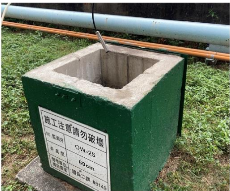
觀測井OW-25放置自計式水位計
