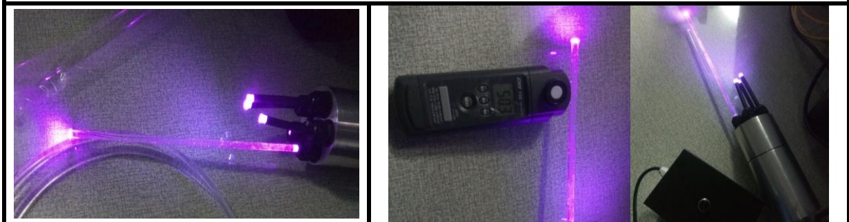
圖 10、石英光纖光強度測試
