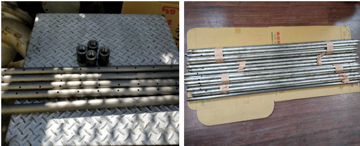
圖 3.3 電動力法之電極材料 (鈦管)
