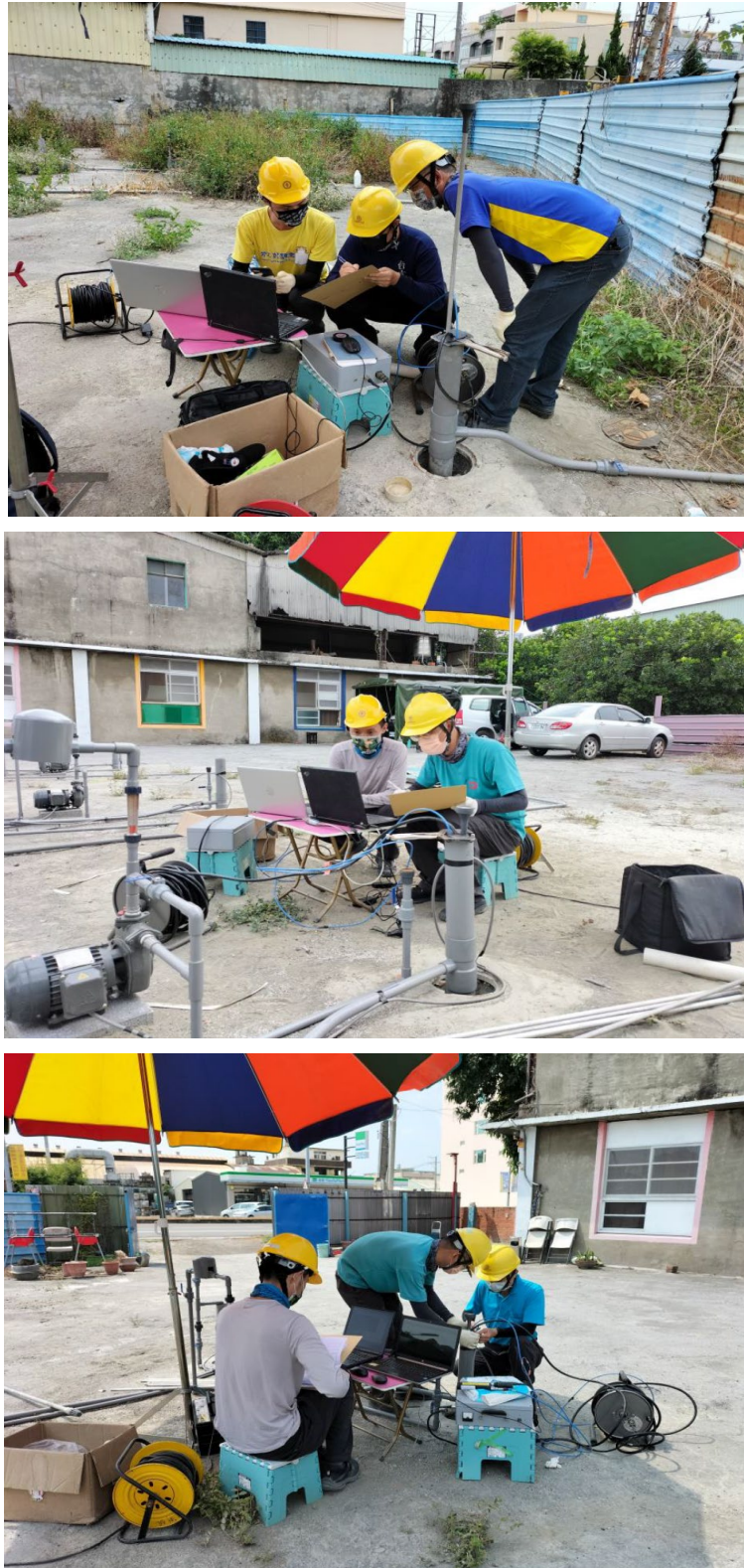
圖 3.11 單井地下水流向流速量測過程
