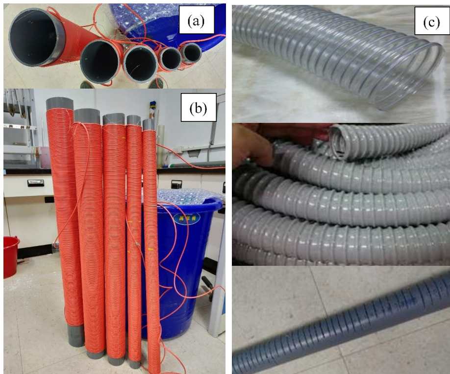
圖 61 高解析度纏繞光纖 (a)纏繞裝置俯視圖(b)纏繞裝置側視圖(c)選用管材
