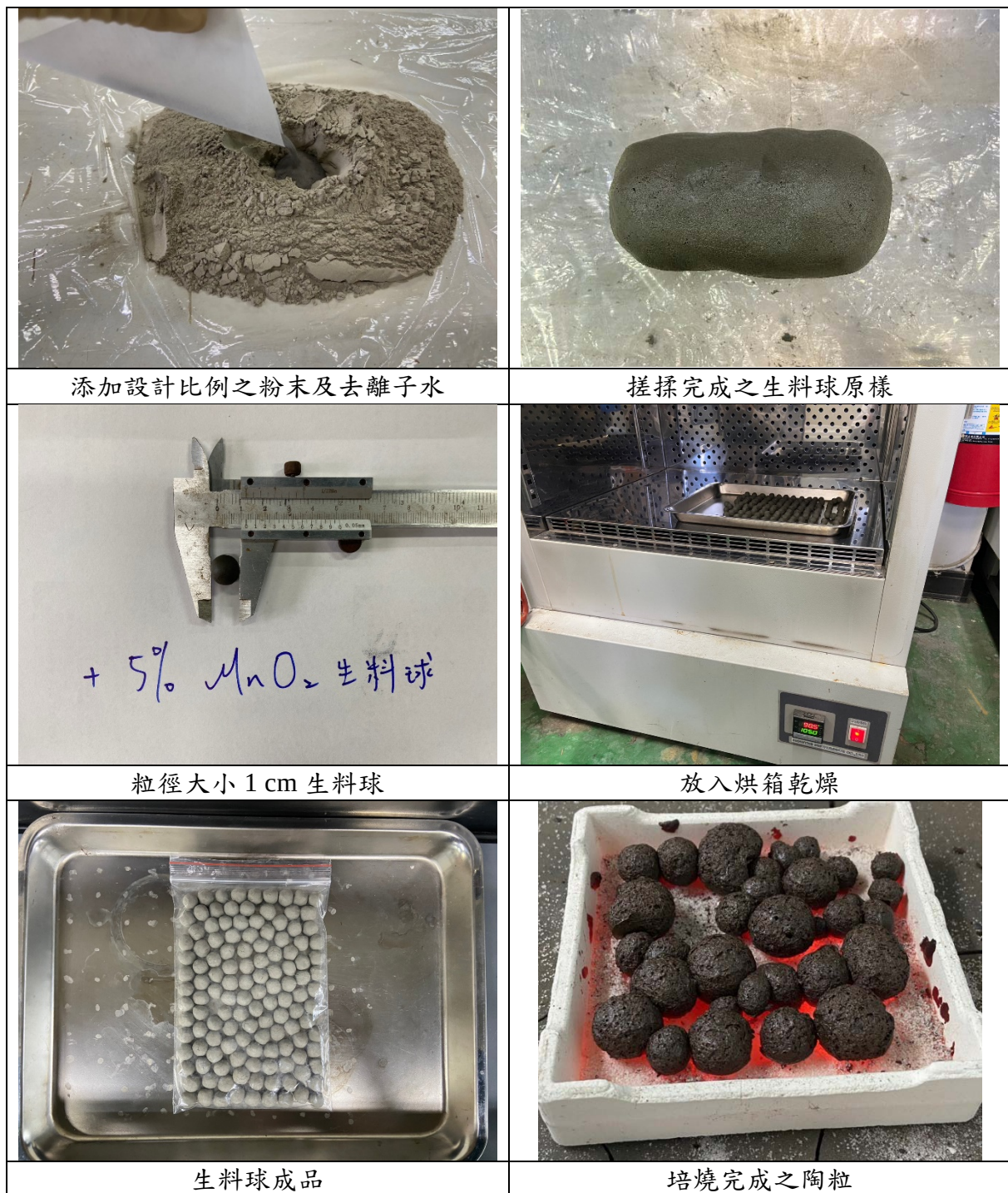
圖4.4.3.1-1 陶粒製備流程
