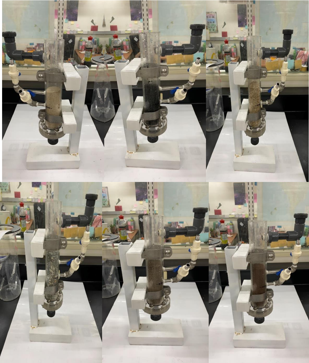
圖 4.6、本團隊選用之濾材及砂濾測試裝置
