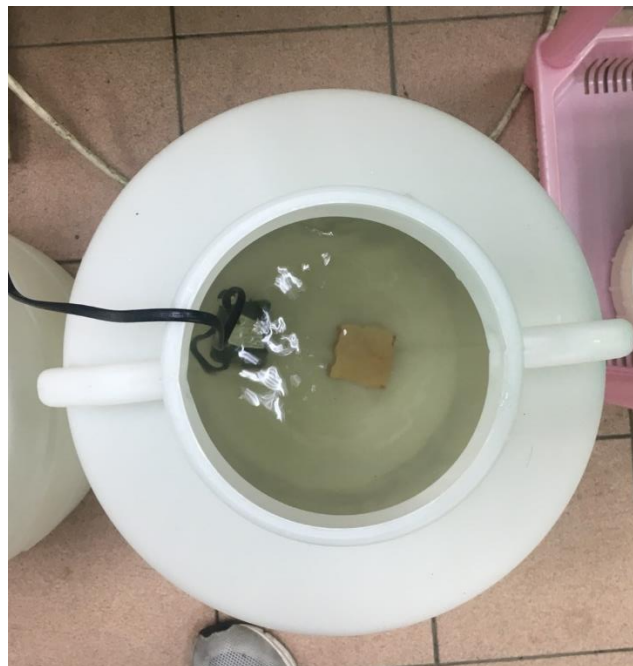
圖4-20試驗磚之浸泡試驗
