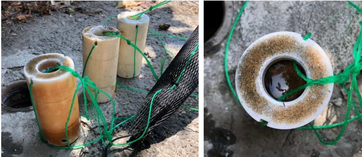
圖 5.4 被動式採樣器之回收過程其採樣器外觀狀態。
