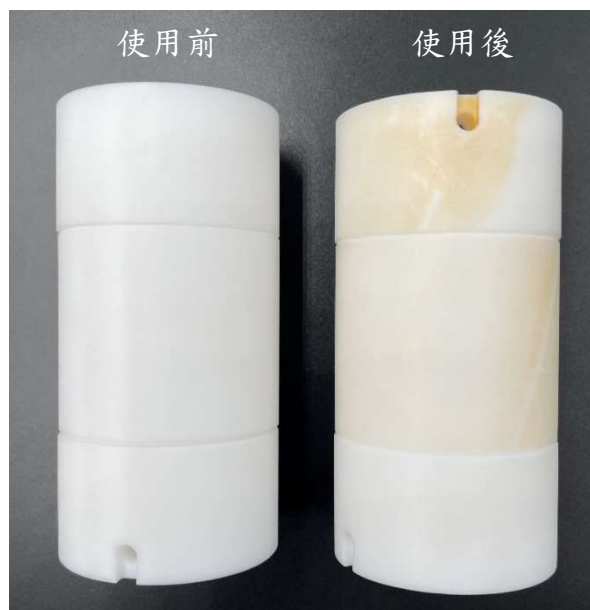
圖 5.5 2 吋被動式採樣器之使用前後對照圖。
