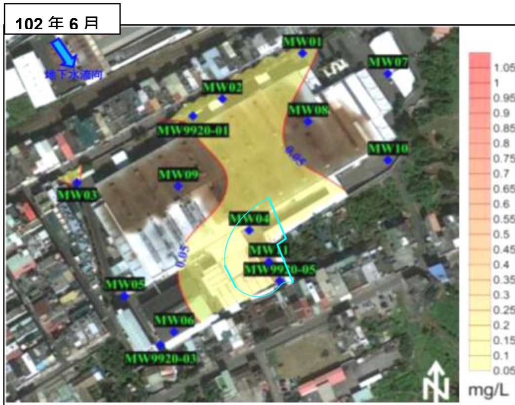
圖 1.2-5 台鈴平鎮廠三氯乙烯濃度推估圖 ( 6/7 )
