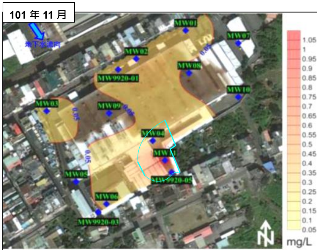
圖 1.2-5 台鈴平鎮廠三氯乙烯濃度推估圖 ( 3/7 )
