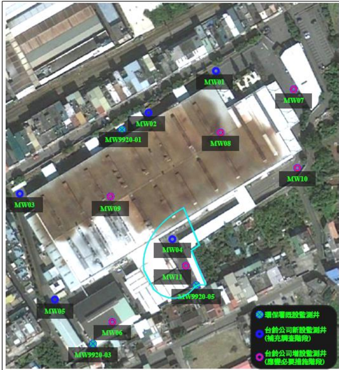
圖 1.2-4 台鈴平鎮廠地下水監測井設置圖
