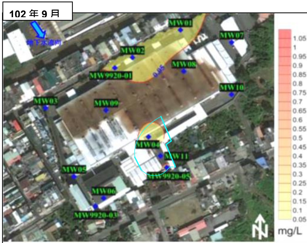
圖 1.2-5 台鈴平鎮廠三氯乙烯濃度推估圖 ( 7/7 )
