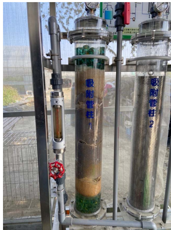
圖4.3.5-3 現地管柱砷移除試驗操作照片
