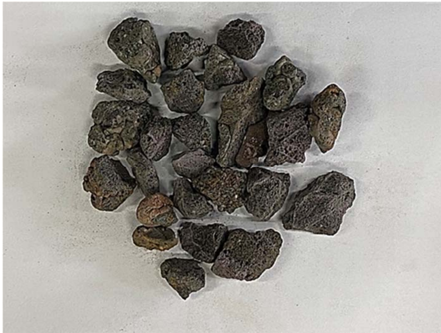
圖4.3.3-1 旋轉窯結圈石外觀
