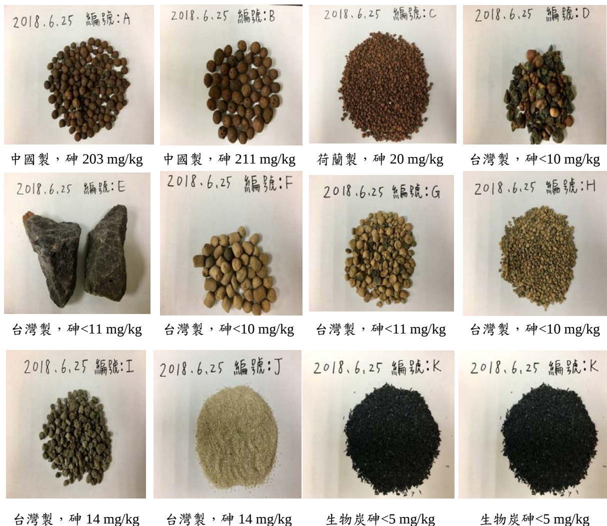
圖2.3-1 砷移除試驗之各種多孔性資材
