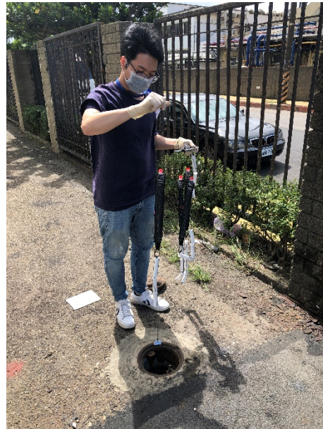
圖 5.14 東陽場址微洗井、被動式採樣器與採樣袋採樣過程照片(續)
