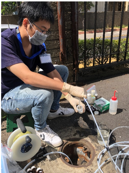
圖 5.14 東陽場址微洗井、被動式採樣器與採樣袋採樣過程照片(續)
