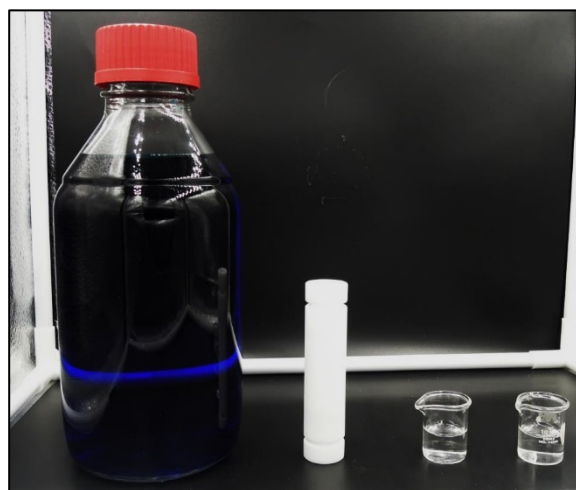
圖 5.2 染劑試驗被動式採樣器內水溶液反應前後之比較
