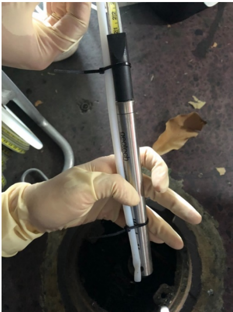
圖 5.14 東陽場址微洗井、被動式採樣器與採樣袋採樣過程照片
