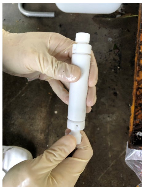
圖 5.14 東陽場址微洗井、被動式採樣器與採樣袋採樣過程照片(續)
