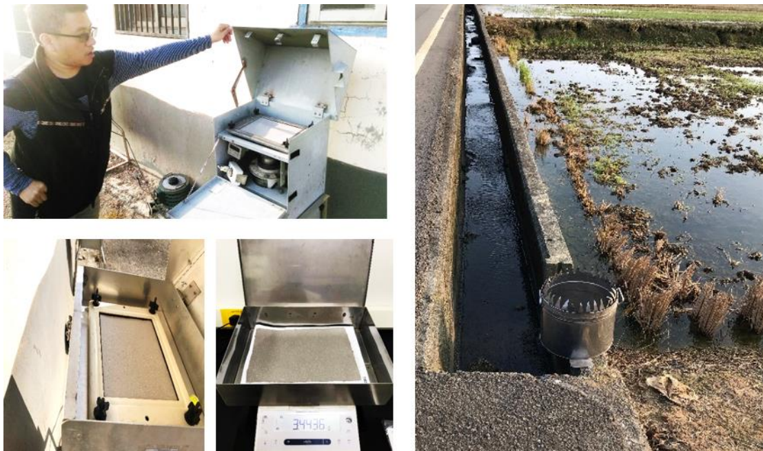
圖二十五、本計畫現地水田高量空氣採樣儀與落塵桶佈放
