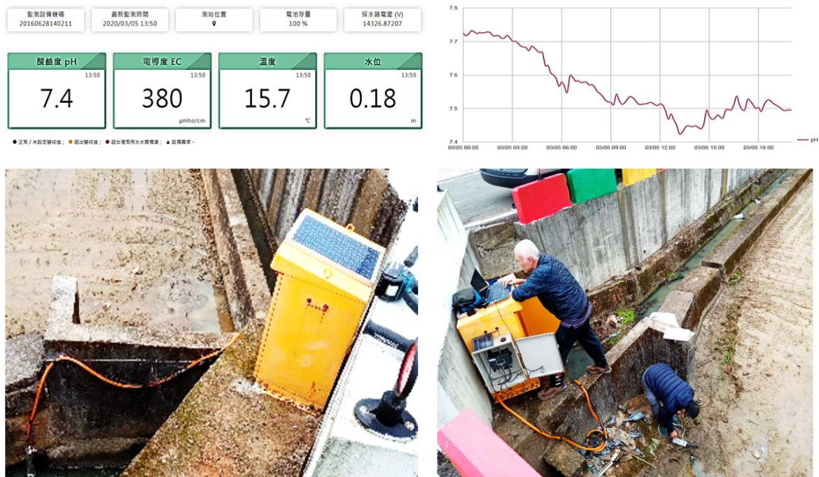
圖二十一、現地灌溉水質自動採樣與監測設備
