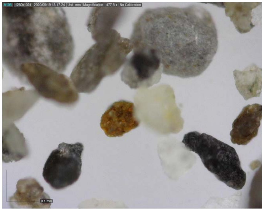
圖 5-23 新漩流器於 11 m/s 流速下之(a)overflow、(b)underflow 土壤顆粒照片
