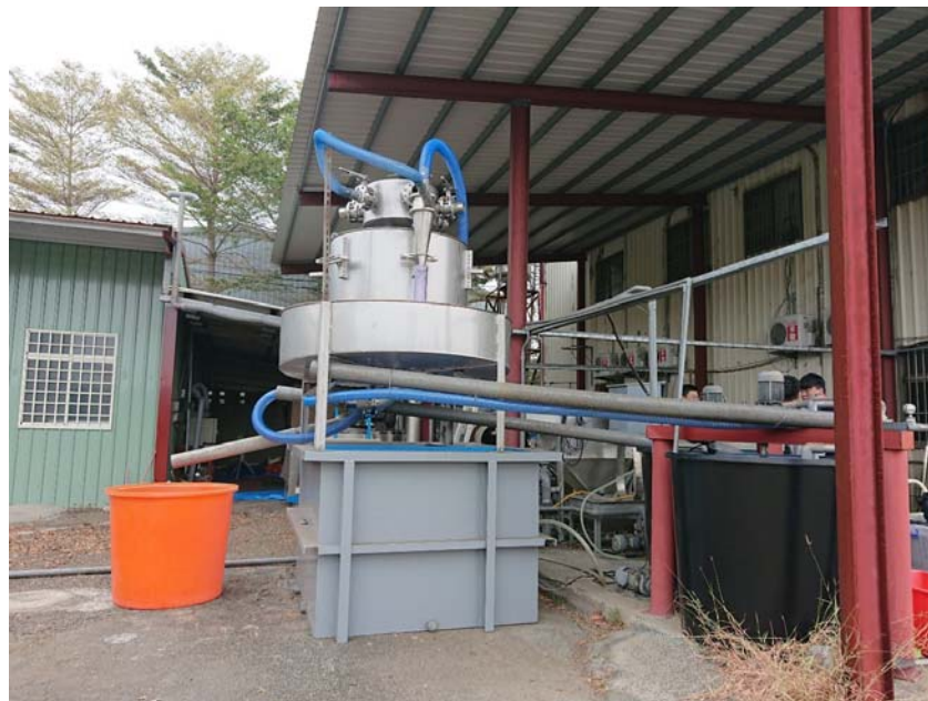
圖 5-9 自組模廠分流槽架設示意圖
