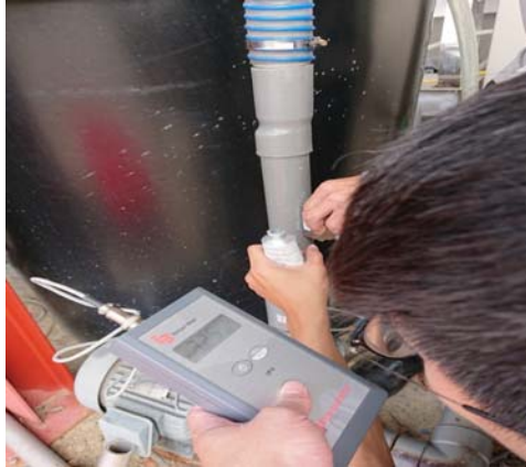
圖 5-12 超音波測速儀監測流速
