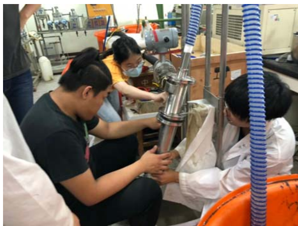
圖 3-1 水力漩流分離器之結構與實驗室組裝照(自有設備)
