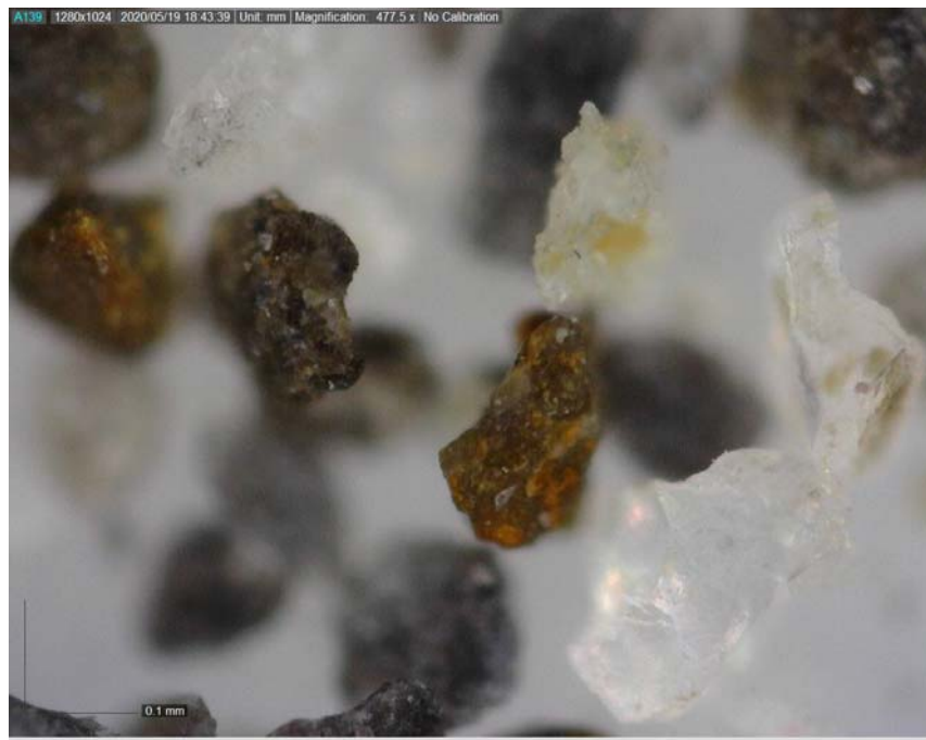
圖 5-25 新漩流器於 13 m/s 流速下之(a)overflow、(b)underflow 土壤顆粒照片
