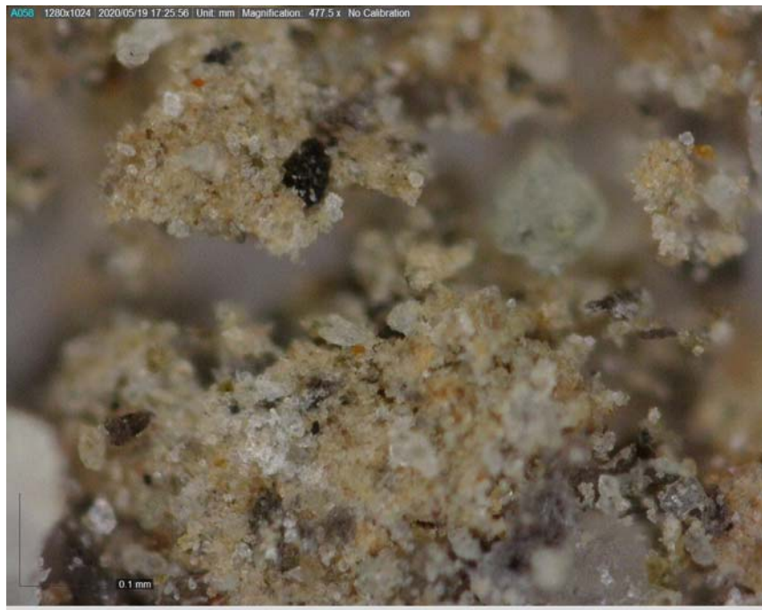
圖 5-19 新漩流器於 7 m/s 流速下之(a)overflow、(b)underflow 土壤顆粒照片
