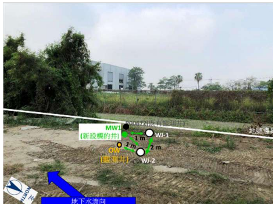
圖 4.4.2-1、水刀注藥施作規劃點位圖
