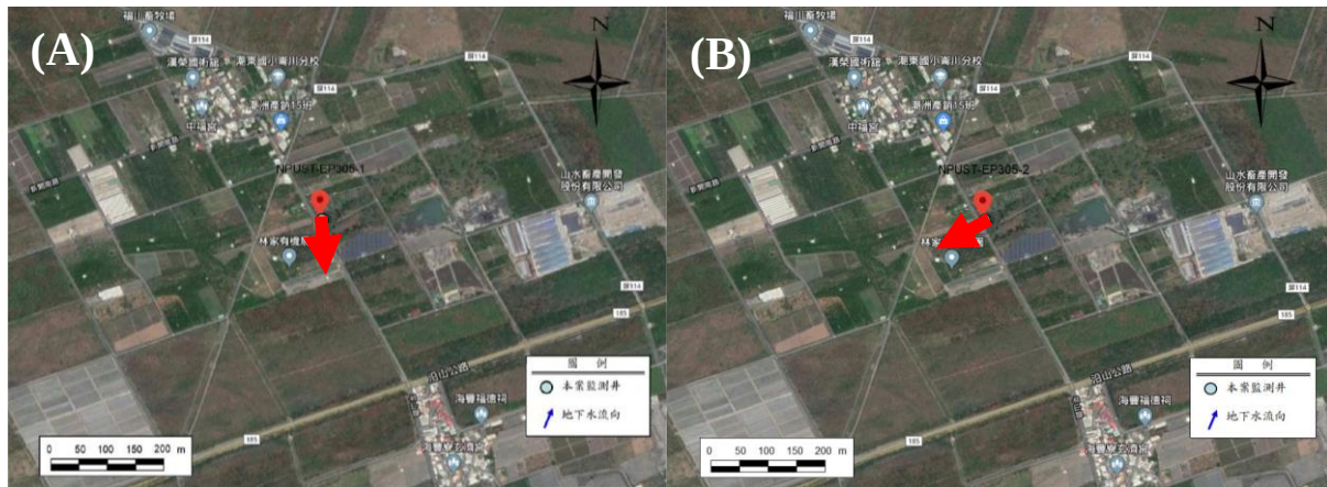
圖33、監測井流向測定示意圖 (紅點為模場位置，測量時間(A) 109/03/06，(B) 109/04/12。)
