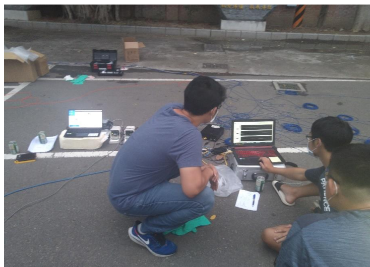
圖 32 光纖光柵解讀儀與電子式導電度計自動化紀錄
