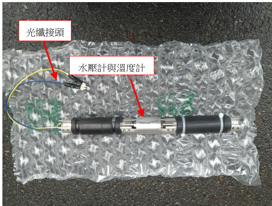
圖 13 Type A 感測器(水壓計與溫度計)
