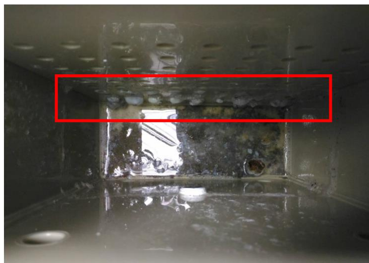
圖 38 1 mM PMS 氧化劑於陽極端產生之乳化物質(2 V/cm)
