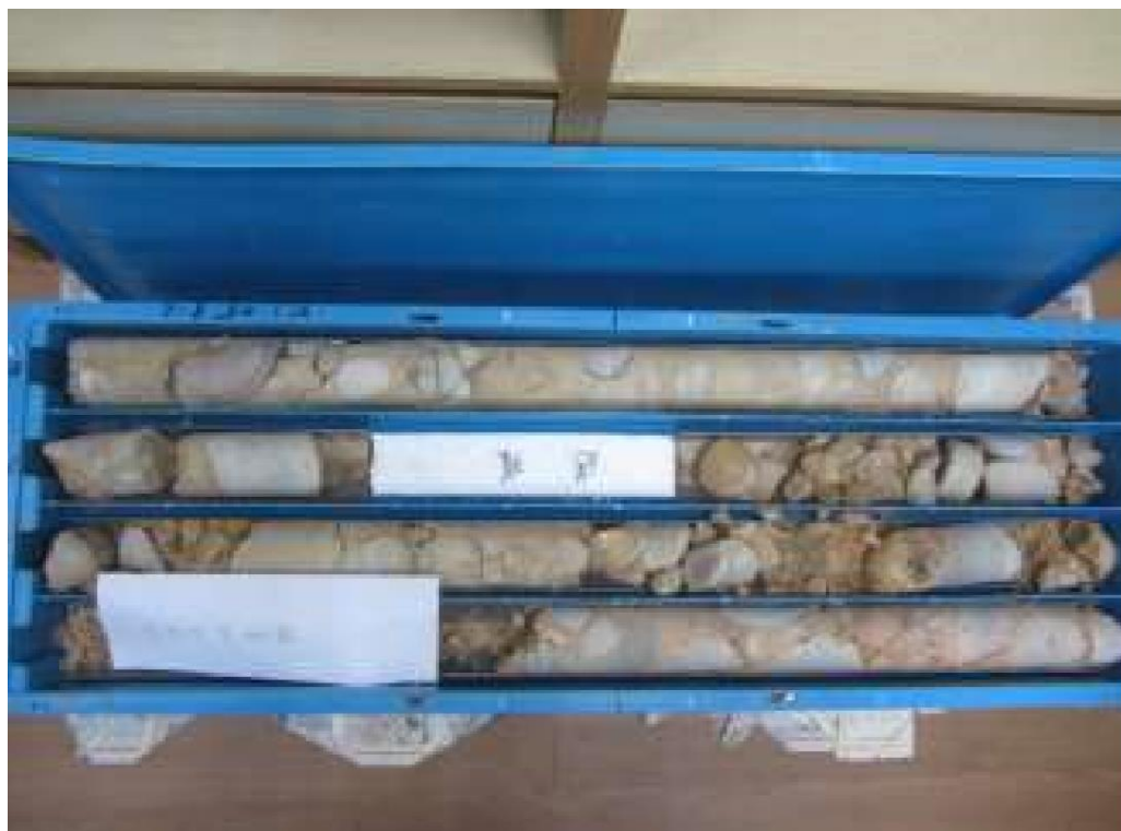
圖 13 試驗場址地質鑽探 5.0~8.0 公尺岩心段
