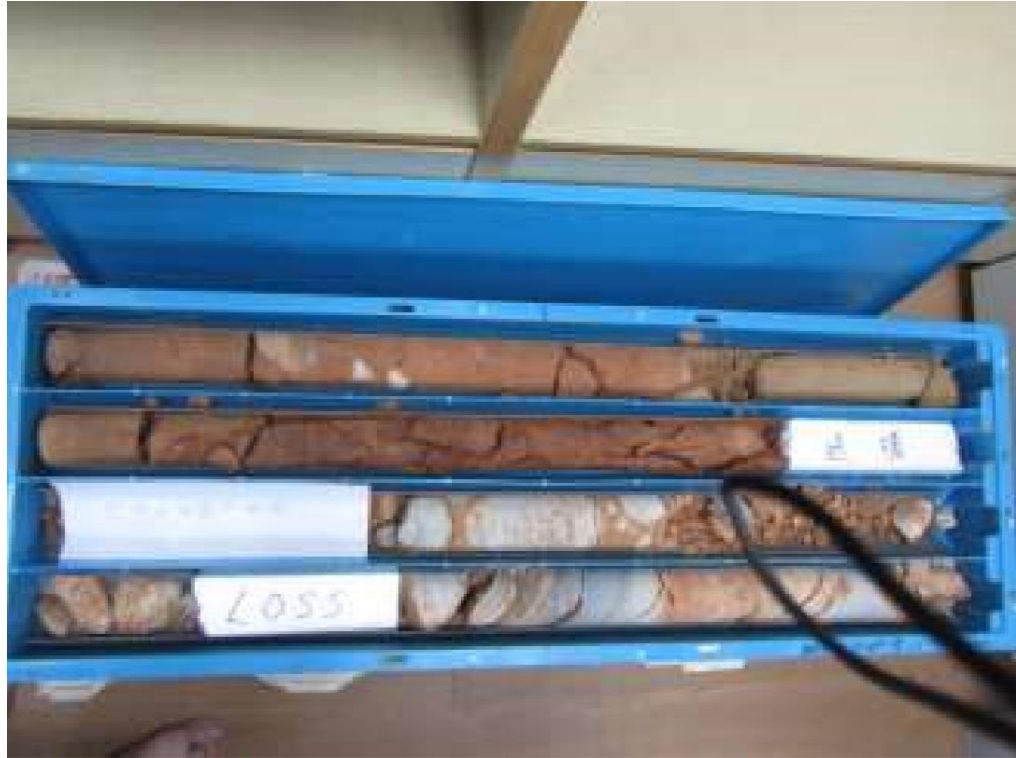
圖 12 試驗場址地質鑽探 0~4.0 公尺岩心段
