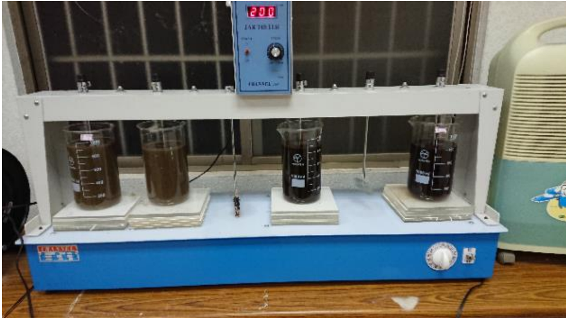
圖 3.4 瓶杯試驗示意圖
