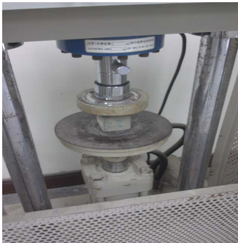
圖 4-10 資材化塊材試體抗壓強度測試照片
