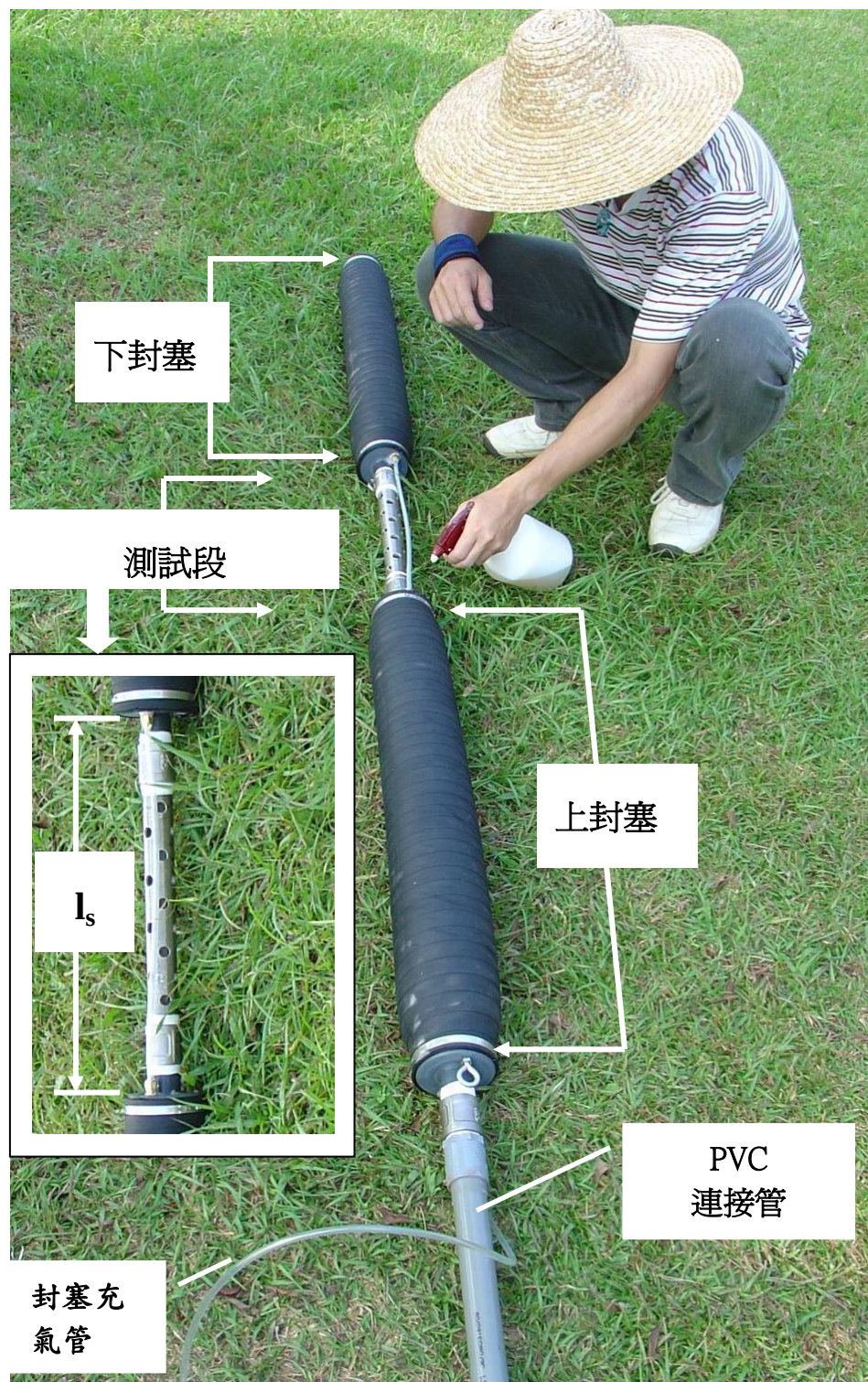
圖 9、雙封塞系統裝置。上、下封塞由可透水的測試段連接，利用 PVC 連接管放置預定試驗深度。封塞通氣管用來將氣體灌入氣囊使直徑擴大。
