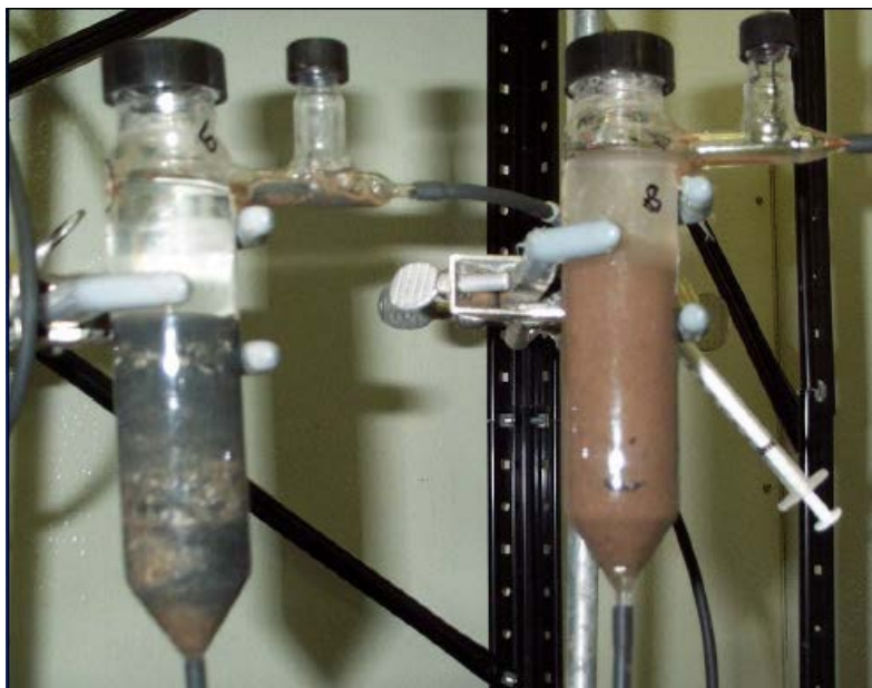
圖 6. 66 受火炸藥污染土壤之奈米零價鐵活性化學還原連續式管柱試驗裝置
