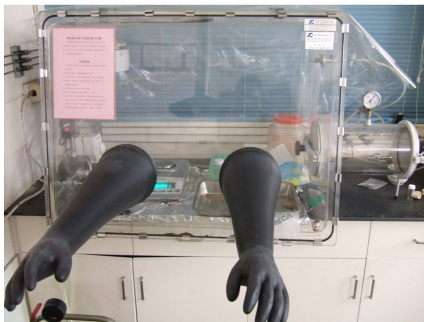
圖 6.1 烘乾之奈米零價鐵粒子保存於絕氧手套箱
