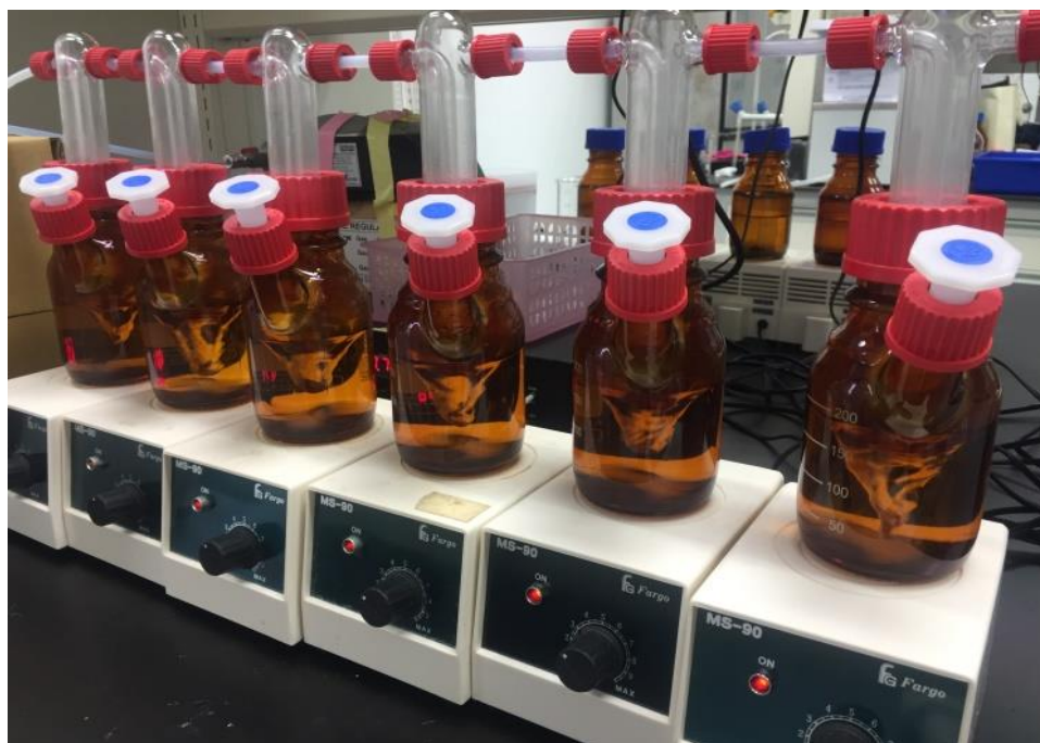
圖 4-2 非揮發性實驗架設與採樣口裝置
