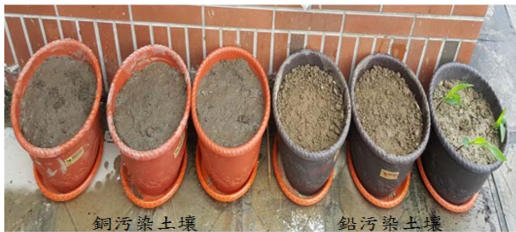
圖 2.2 鉛銅污染土壤盆栽試驗示意圖
