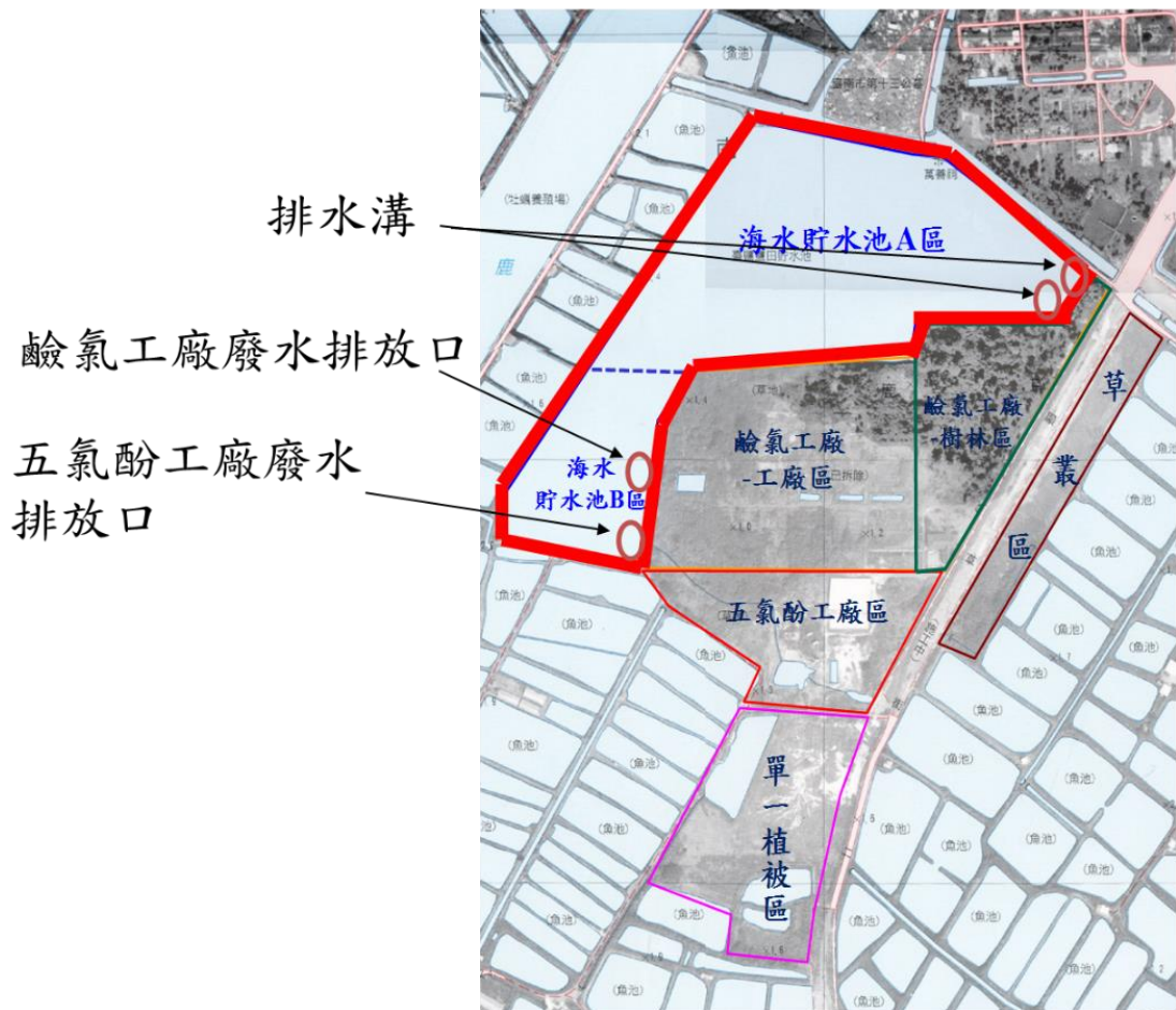
圖 1.6.2-1 鹼氯工廠及五氯酚工廠廢水排放口進入海水貯水池相對位置
