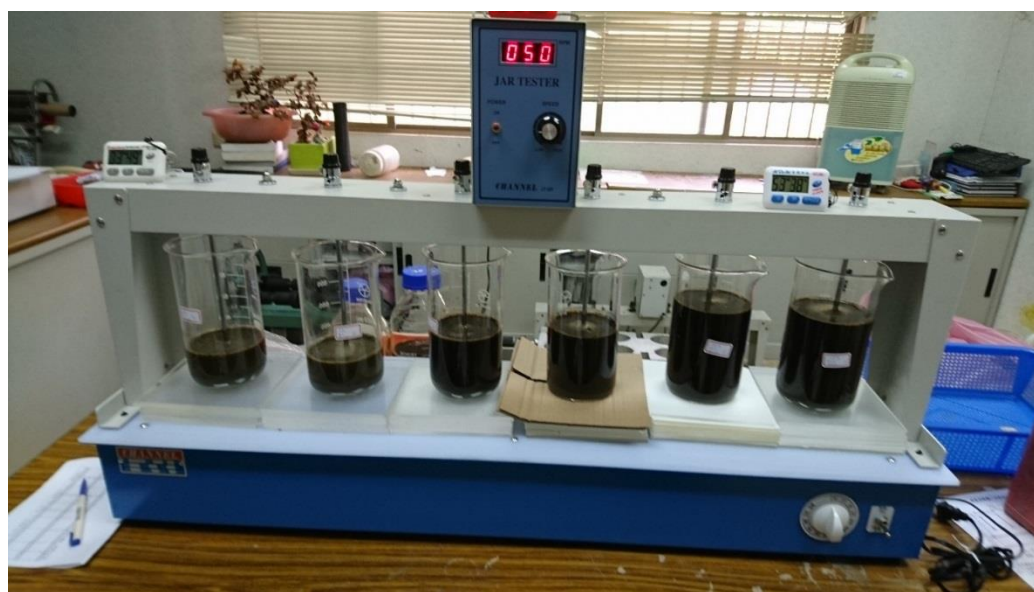
圖 3.7 瓶杯試驗示意圖
