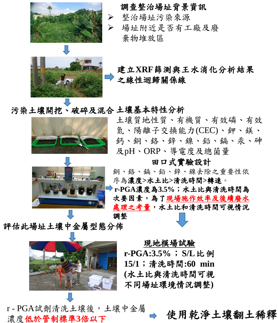
圖 4.38 現場整治作業程序流程
