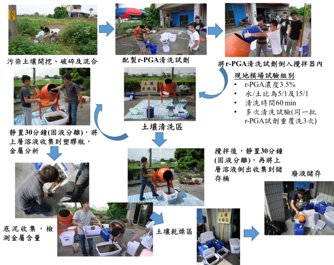
圖 4.29 現地清洗作業流程圖
