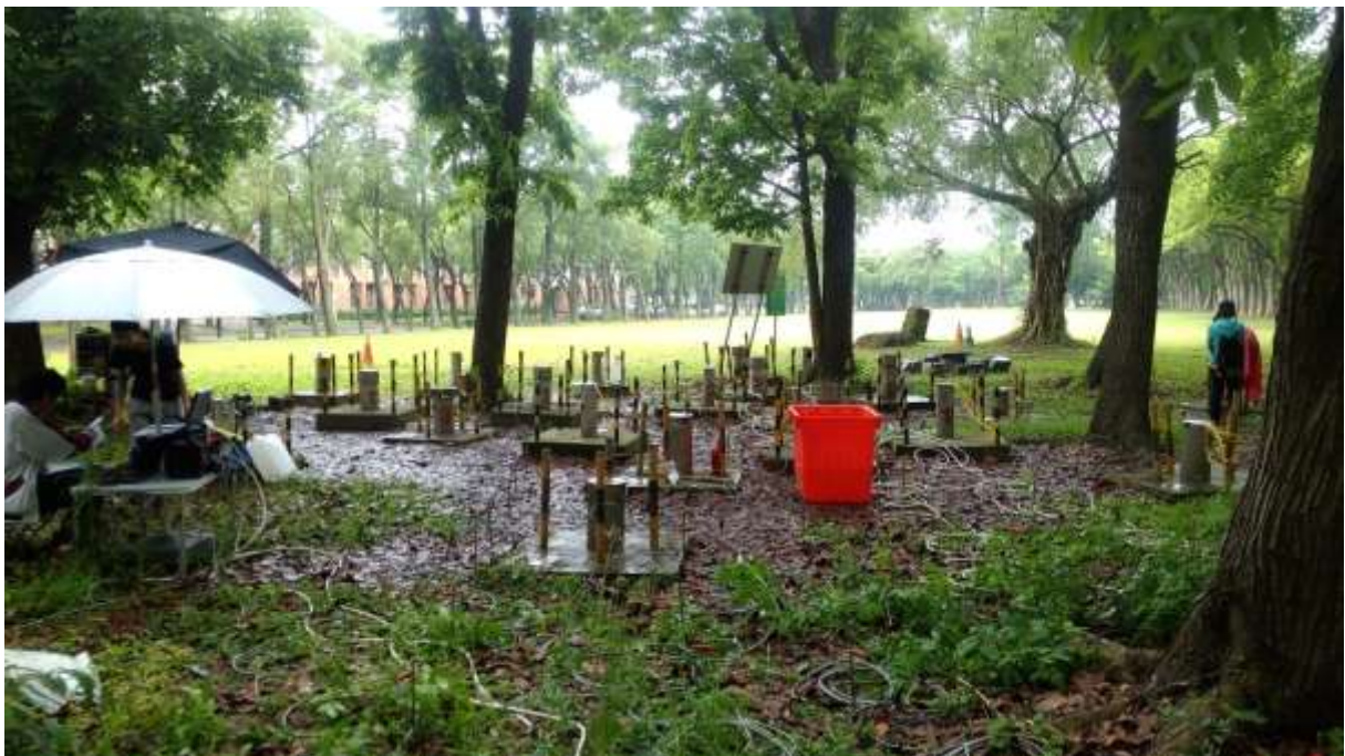
圖 4-12、五測線地電阻設置現場照片(2/2)
