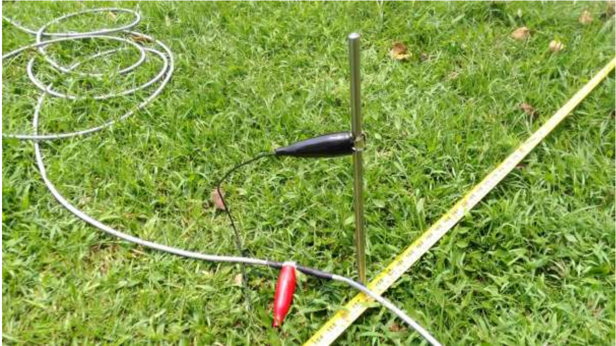
圖 4-13、地電阻纜線連結接地電極棒照片
