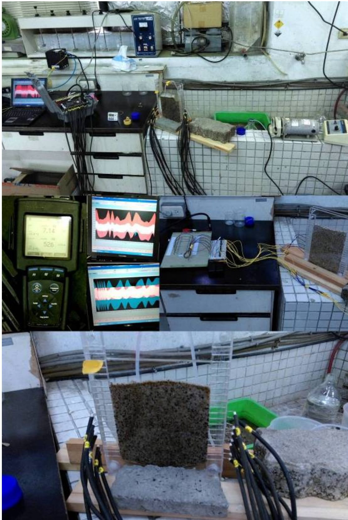
圖 3.5-1 第一階段自然電位法砂箱實驗照片
