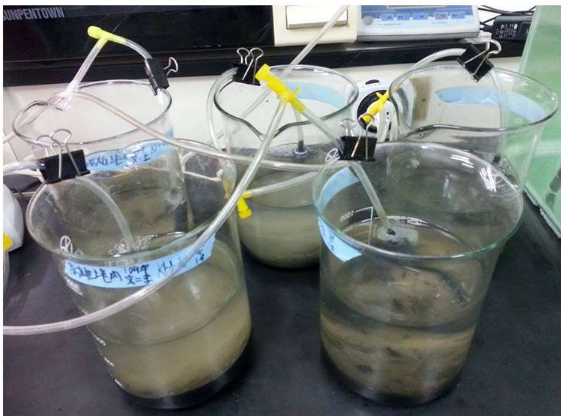
圖 3.2 端足類於燒杯中進行底泥毒性測試
