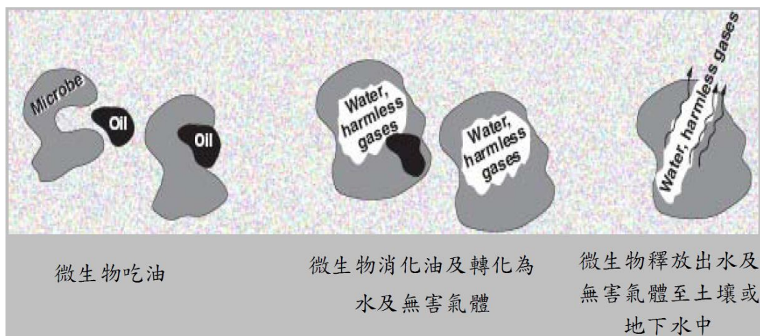
圖 3.1 微生物處理有機污染物之概念示意圖
