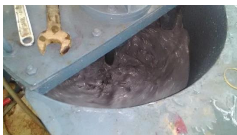
圖 4.36 基質高速拌合情形
