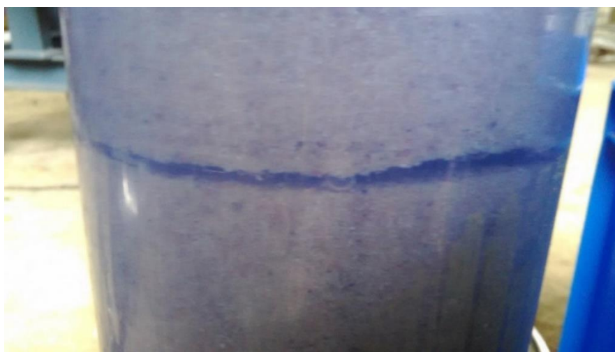
圖 4.35 砂柱試體之劈裂現象
