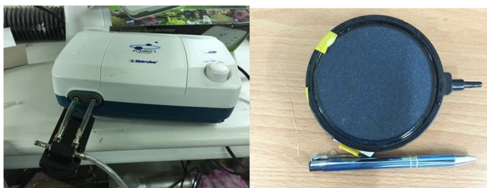
圖 31 氣泡產生器：空氣壓縮機(左)透水石(右)
