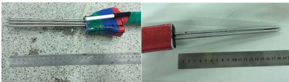
圖 30 TDR 三叉式(左)與雙叉式(右)感測器
