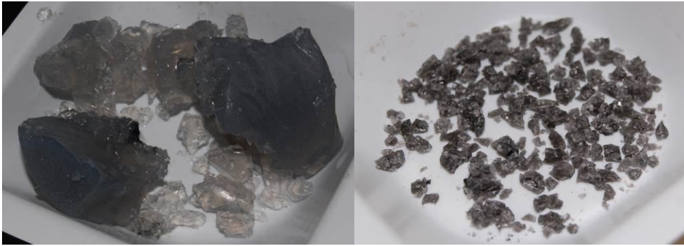
圖 7 以溶膠凝膠法製備之複合吸附材-未真空乾燥前(a)與真空乾燥後(a)
