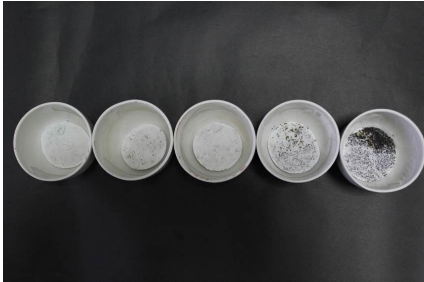
圖 22 在低溫 500℃ 下底泥玻璃化成品
