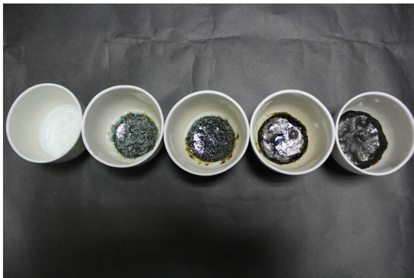
圖 23 在高溫 1100℃ 下底泥玻璃化之成品
