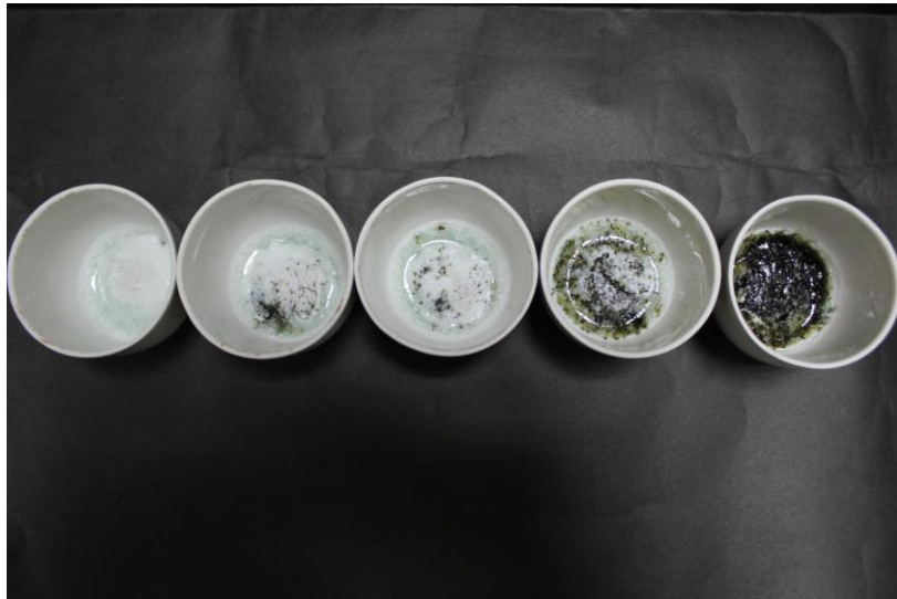
圖 28 高溫爐加熱至 1000℃ 之底泥玻璃化情形
