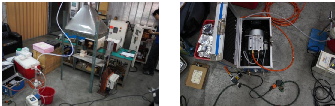
圖 30 現場玻璃化實驗時採集空氣污染物之裝置圖
