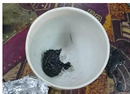
圖 26 玻璃化固化冷卻後之底泥
