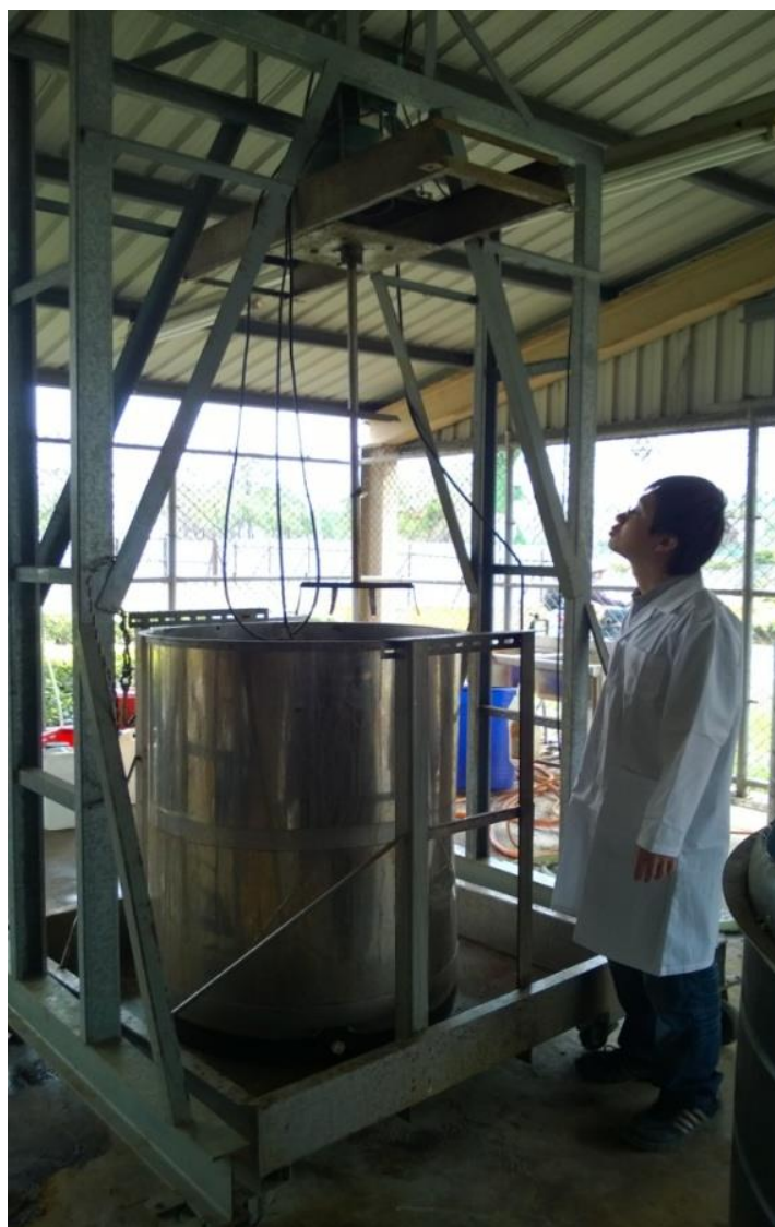
圖 3.11 量產 Fe/Al 複合金屬之合成設備(每批次 10 kg)
