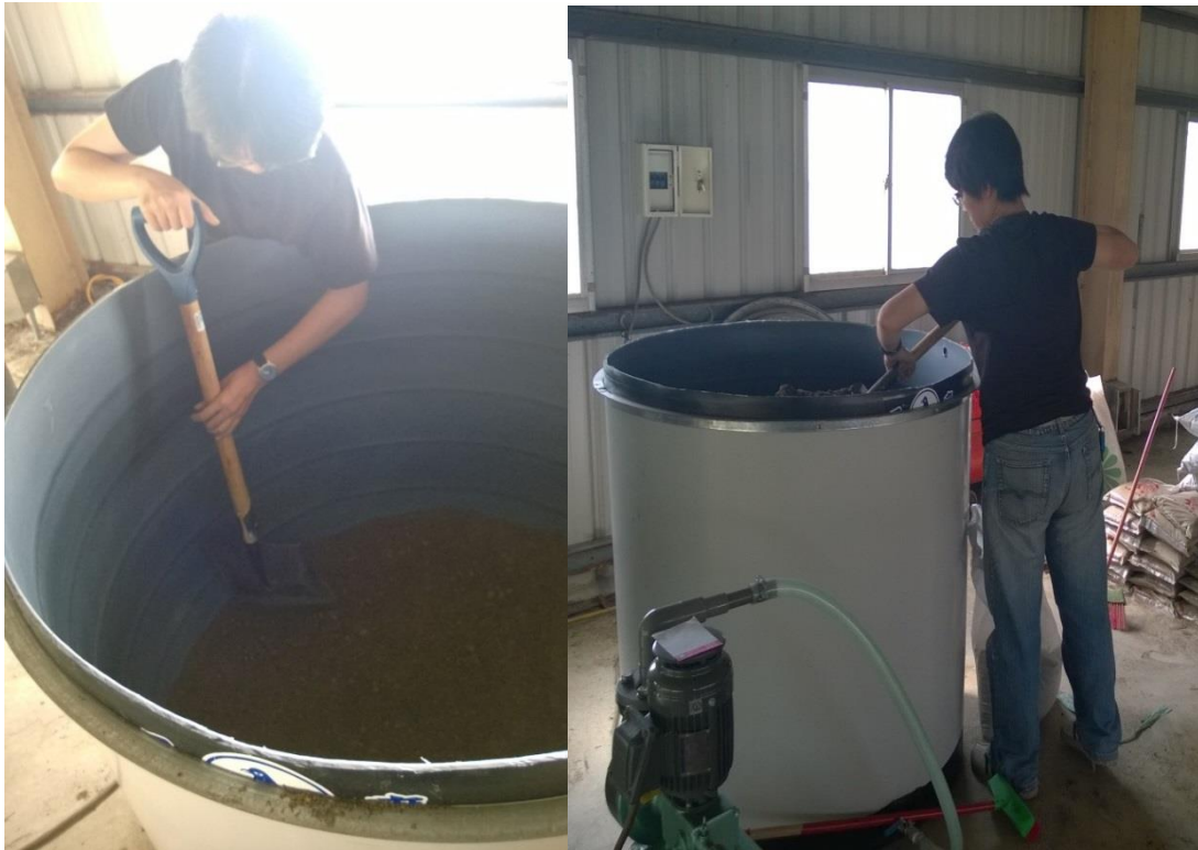
圖 4.12 廠型模組反應槽內之土壤及鐵鋁複合金屬填充情形
