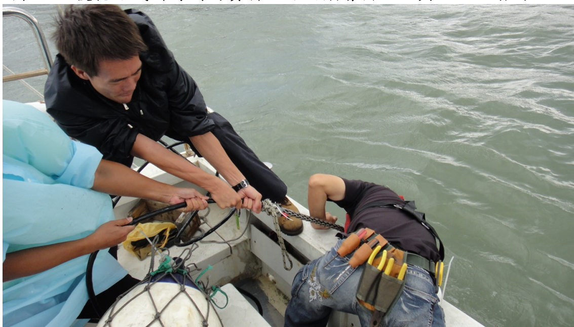
圖 95 拖行途中容易勾到漂流物，需要將拖魚拉回進行清理
