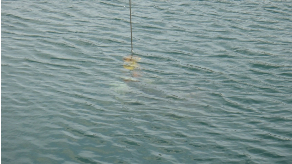
圖 66 利用在吊車剛纜上所做的距離記號（白色標籤），將儀器下放至離水面 1 公尺處
