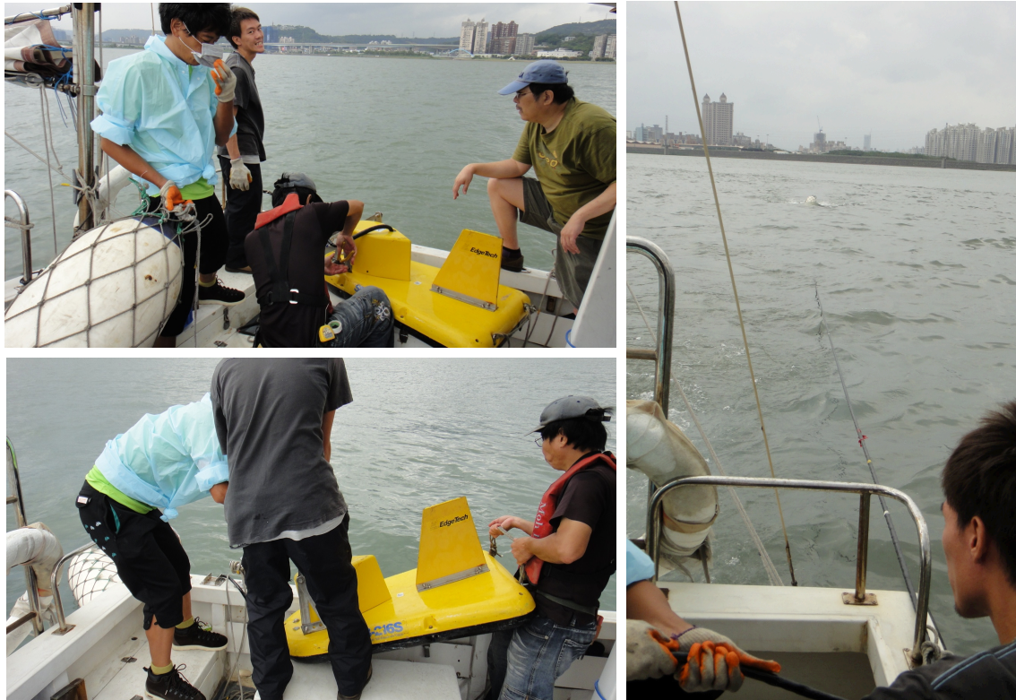
圖 93 加裝浮球在纜線上以及拖行狀況
