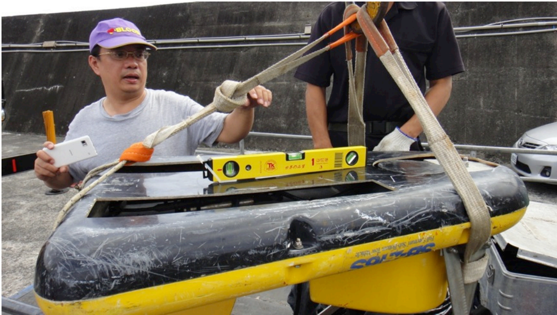
圖 60 確認地層剖面儀的平衡狀態
