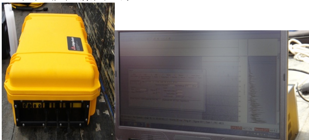
圖 65（左）地層剖面儀操作主機；（右）實際操作的電腦畫面
