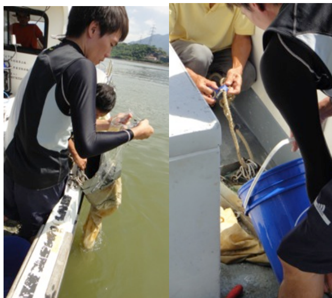
圖 48（左）使用底拖式的網子進行底泥採樣；（右）每採一個點位後進行清洗作業
