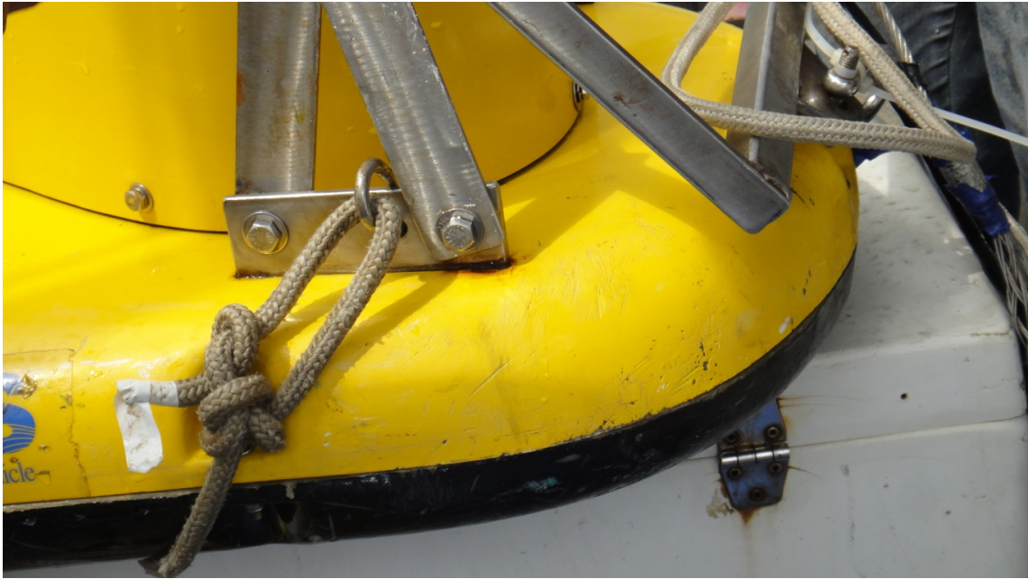
圖 90 因無法從拖魚的其他地方找出合適的固定點，只好從拖魚右側底部拉一條繩子固定
