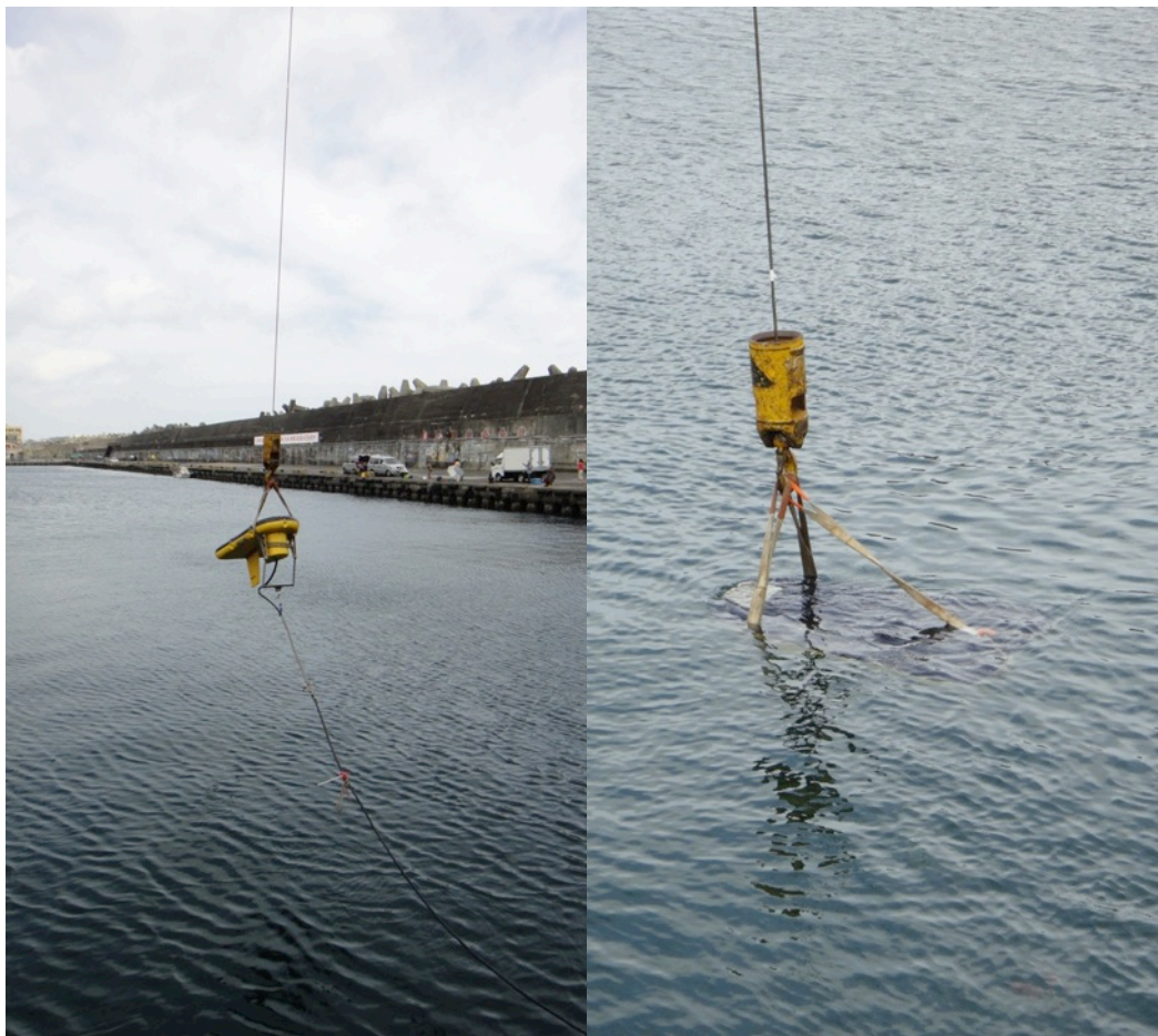
圖 64（左）調整後的儀器平衡狀態，使前端稍微翹起，這樣進入水中後因負重會下沉較多，使得儀器在水中是平衡狀態；（右）儀器進入水中後呈現平衡狀態
