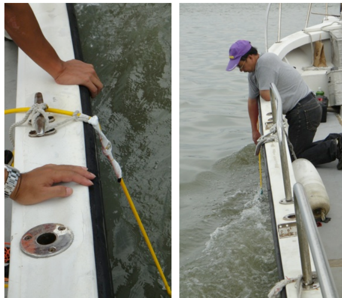
圖 84 因直接用纜線進行拖曳作業，以短繩固定纜線於船側；檢查纜線吃力狀況
