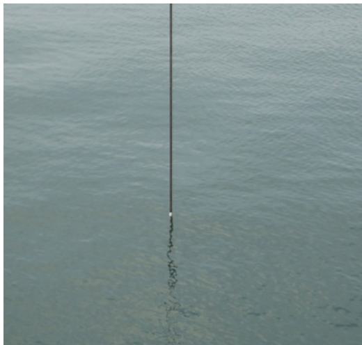
圖 67 利用在吊車剛纜上所做的距離記號（白色標籤），將儀器下放至離水面 4 公尺處
