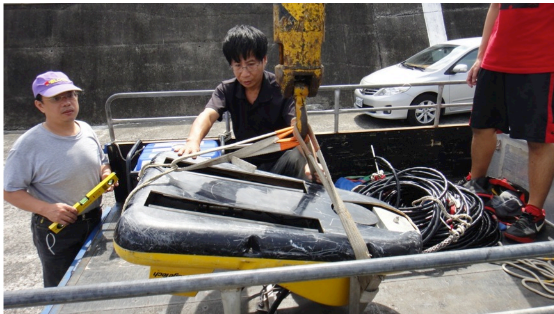
圖 57 藉由調整連結吊車吊臂的帶子來控制地層剖面儀的狀態
