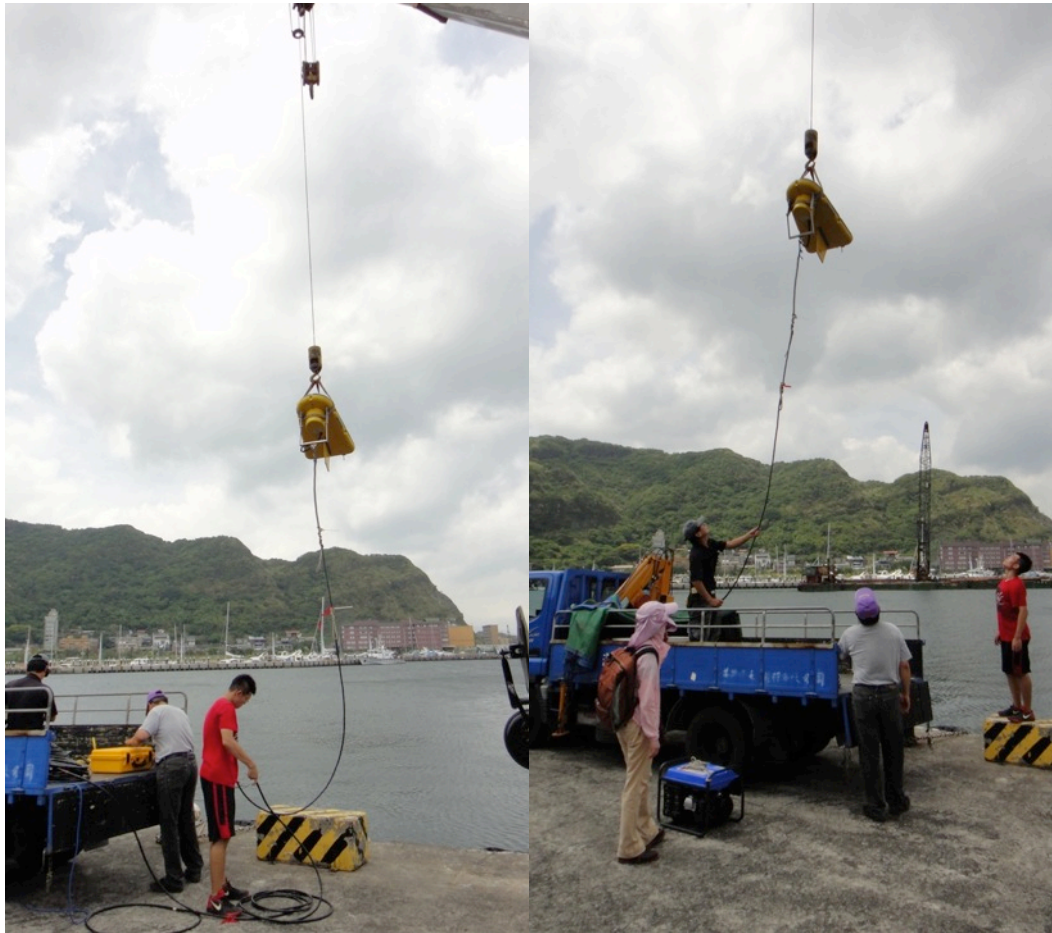
圖 71 (左) 邊將儀器吊起，邊收拾儀器纜線；(右) 將儀器吊至車上
