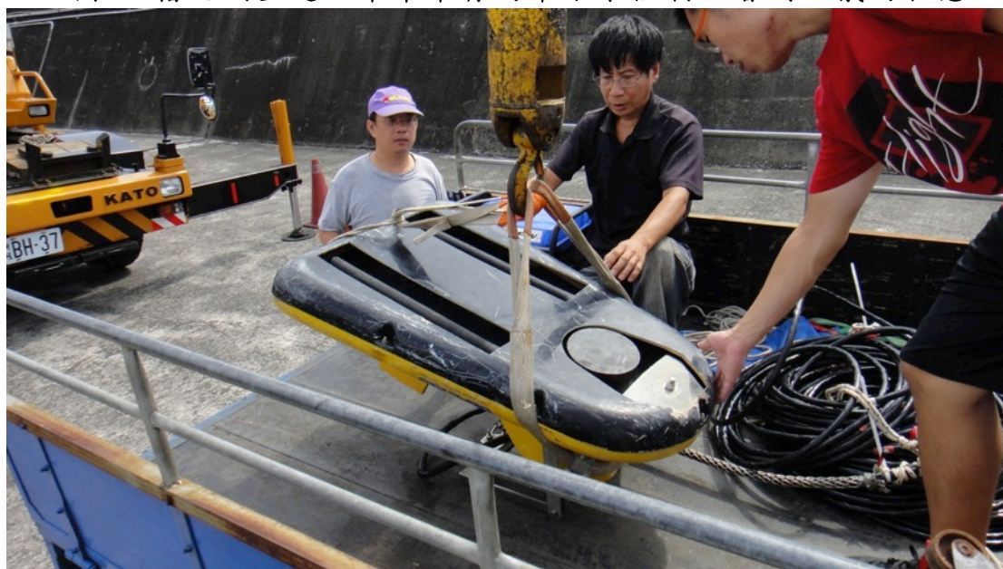
圖 58 因地層剖面儀前端置有負重物，以利正常施放時不會受水流影響而翻轉，因此重量並不平均，所以難以平衡儀器。
