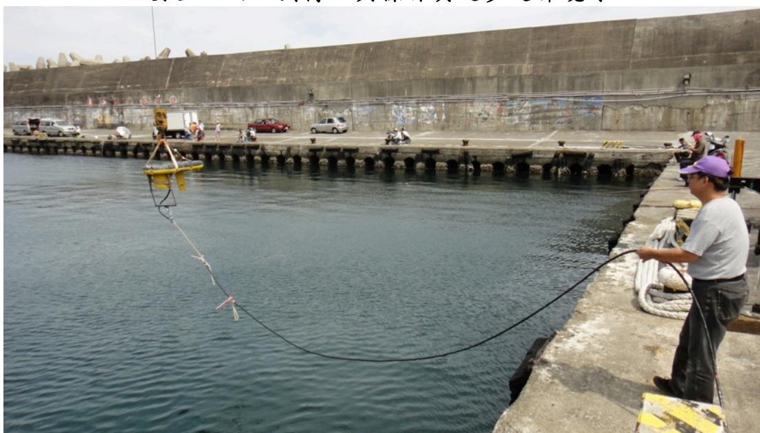
圖 62 儀器逐漸接近水面，此時水面相當平靜，估計水面波高約 1-3 公分
