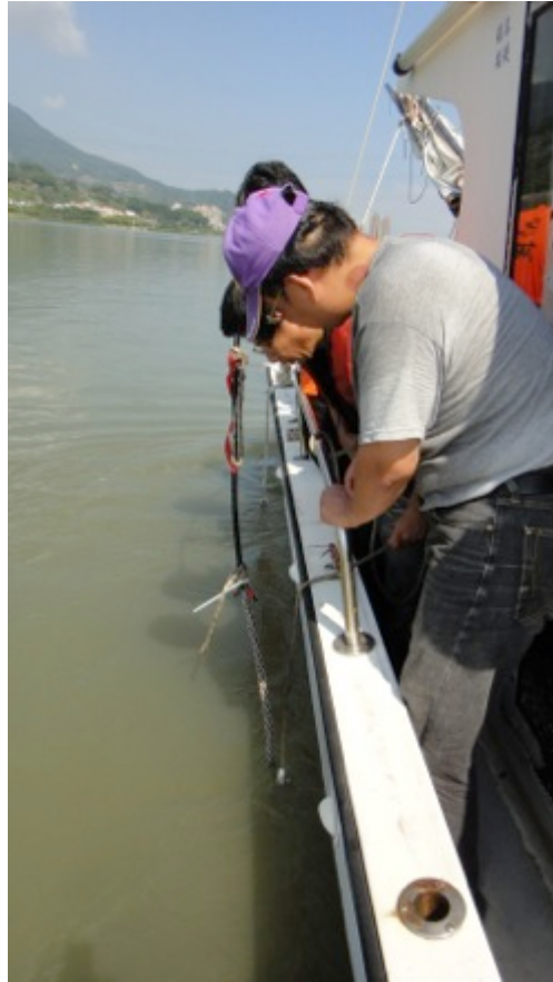
圖 80 將 SB 移至船側中央處，深度為水下 2 公尺
