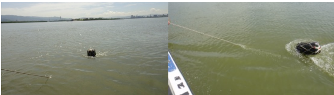
圖 47（左）拖行時將浮體固定在繩子上，讓網子在脫離採樣點位之後，因船速使得網子浮起來，避免混到周圍底泥；（右）拖行時的樣子
