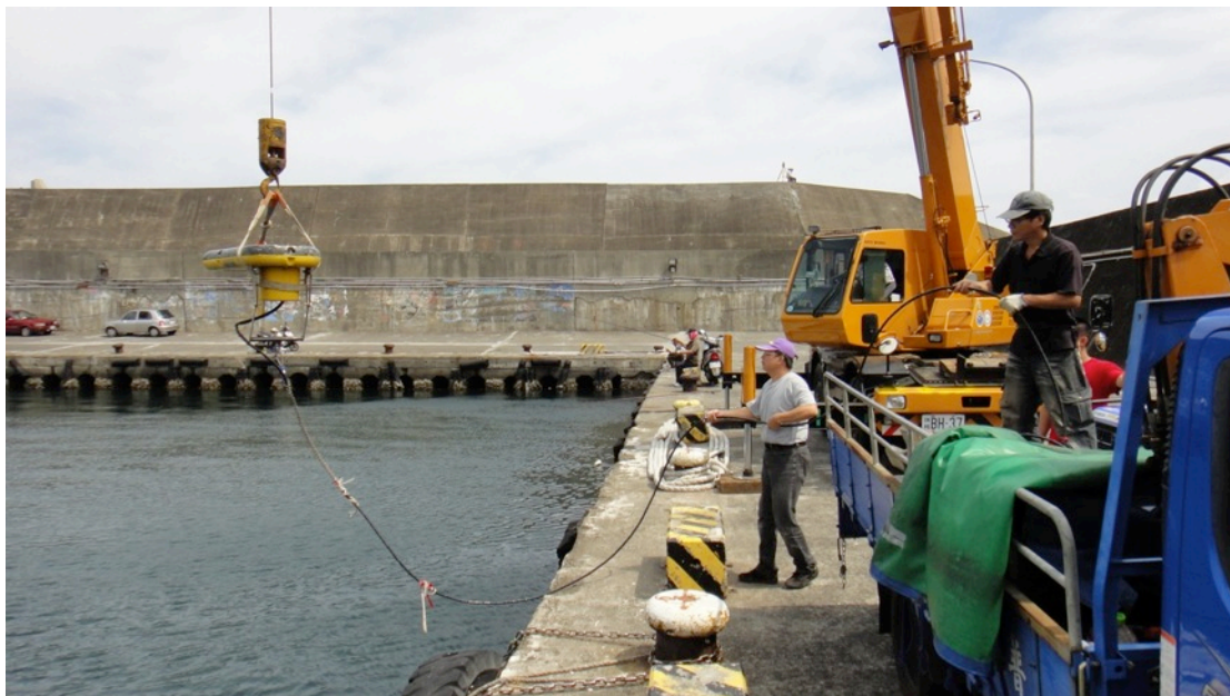
圖 61 藉由吊車將地層剖面儀吊起，並放入水中。為確保儀器纜線的安全，因此劉博士與操作員逐步延伸纜線。
