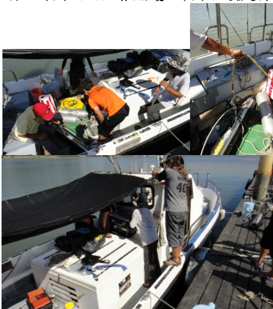
圖 45 （左上）側掃聲納與抓泥機；（右上）側掃聲納準備作業； （下）GPS 衛星定位系統準備作業
