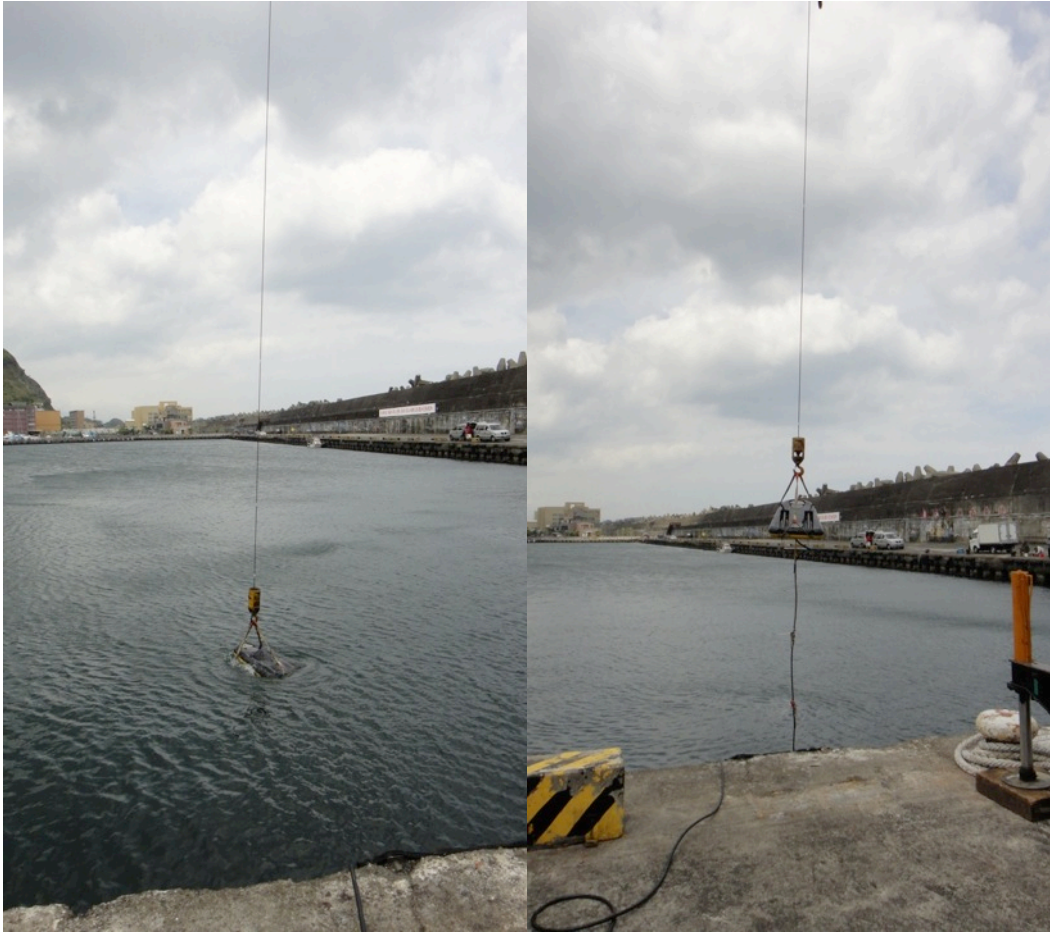
圖 70 把地層剖面儀從水中吊起，此時水面因受風吹影響，水面波高估計約 5 公分
