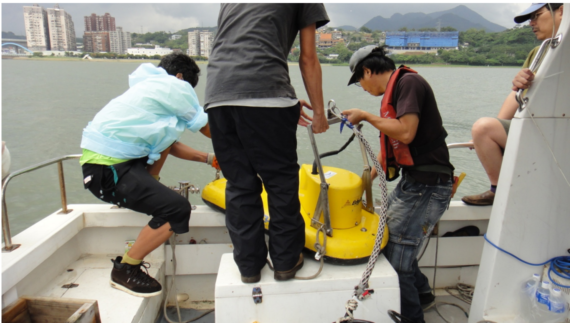
圖 91 將拖魚以兩條繩子固定：中央纜線以及右側底部
