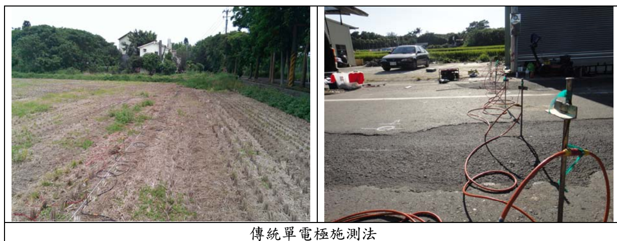
圖179、感應極化法之單電極施測法
