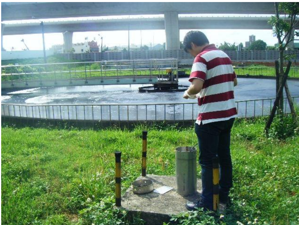
圖十四、五月雨季工業局汙水廠 CL01 地下水取樣
